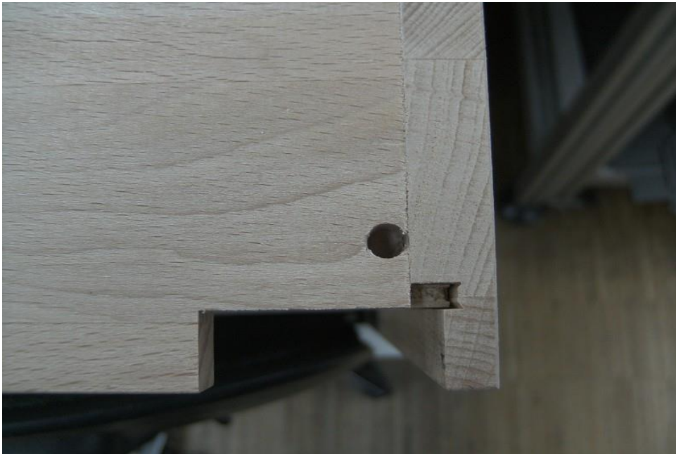
Resim 3.16 Ahşap kaplamalı çekmece sistemi bağlantı arka görünüş resmi [17]
