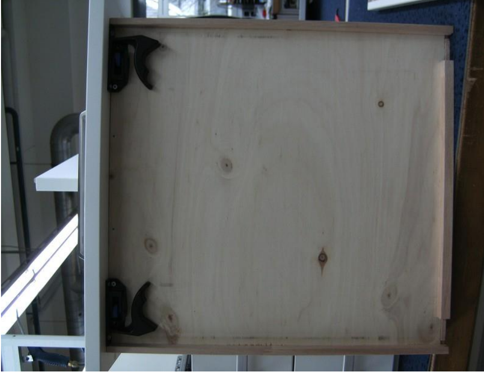
Resim 3.17 Ahşap kaplamalı çekmece sistemi bağlantı alt görünüş resmi [17]
