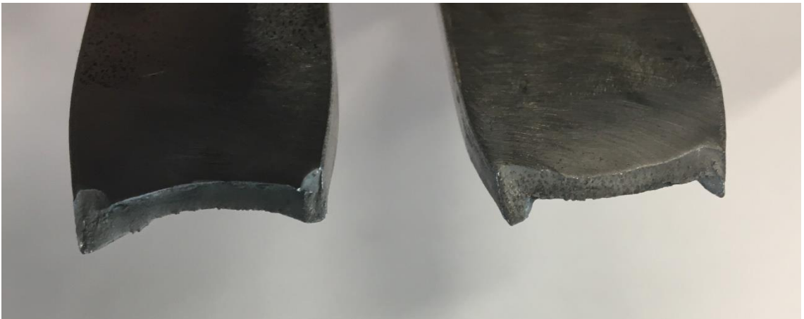
Şekil 31. Numune 4' ün çekme deneyi sonrası kopma kesitine ait makro görüntü
