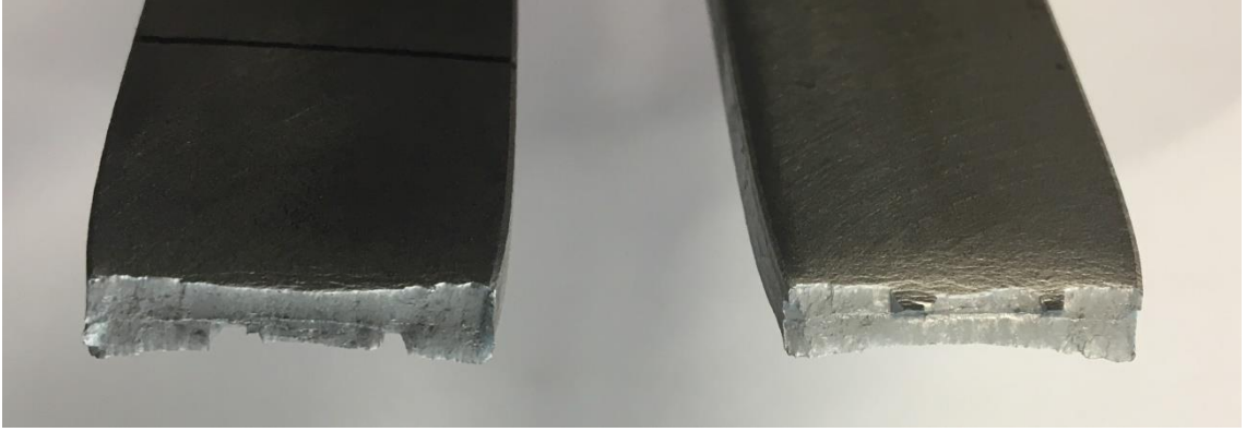
Şekil 26. 2205 ana metalin çekme deneyi sonrası kopma kesitine ait makro görüntü
