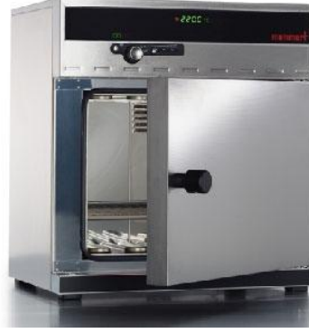
Şekil 3.7. Isıl yaşlanma testlerinin yapıldığı etüv.
