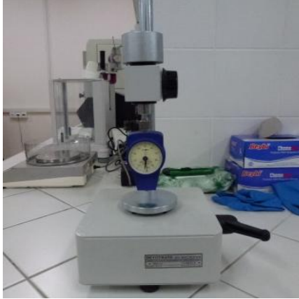
Şekil 3.4. Sertlik ölçer (Shore A tipi).
