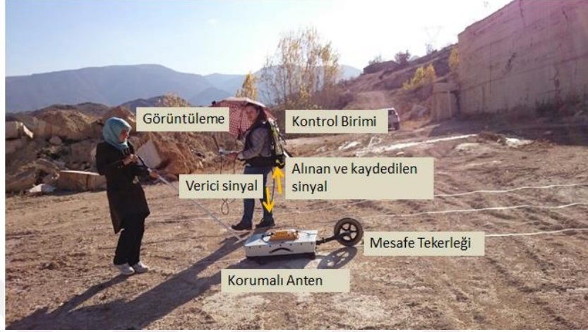
Şekil 1.1. Yer Radarı ölçüm düzeneği
