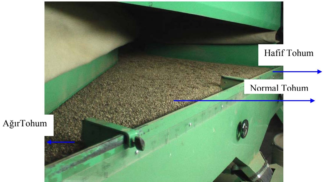
Şekil 1.25 Gravite eleğinde tohumluğun ayrılması
