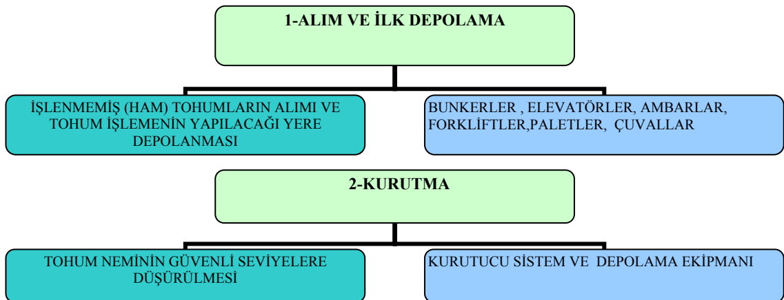
Şekil 1.2 Tohum temizleme ve sınıflandırmanın aşamaları ve bu amaçla kullanılan makineler (Gregg ve Billups 2010a)
