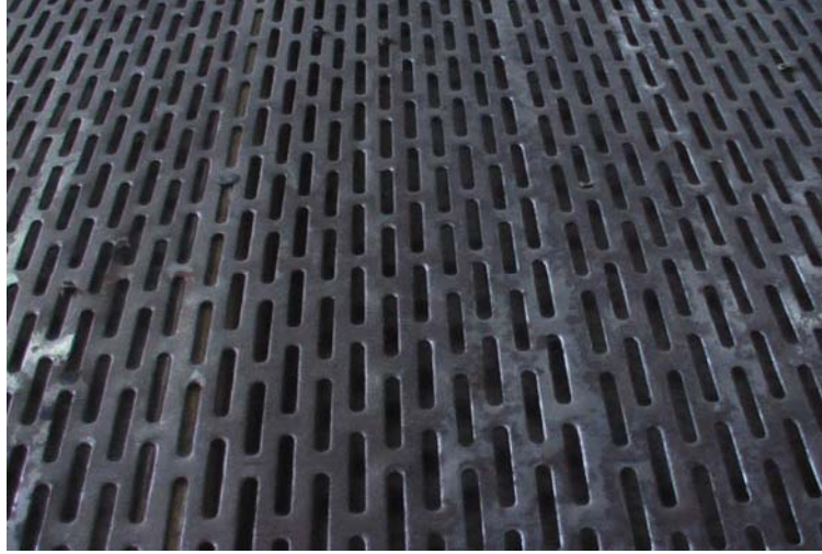
Şekil 1.15 Şeker pancarı tohumunun ayrılmasında kullanılan oblong delikli elek
