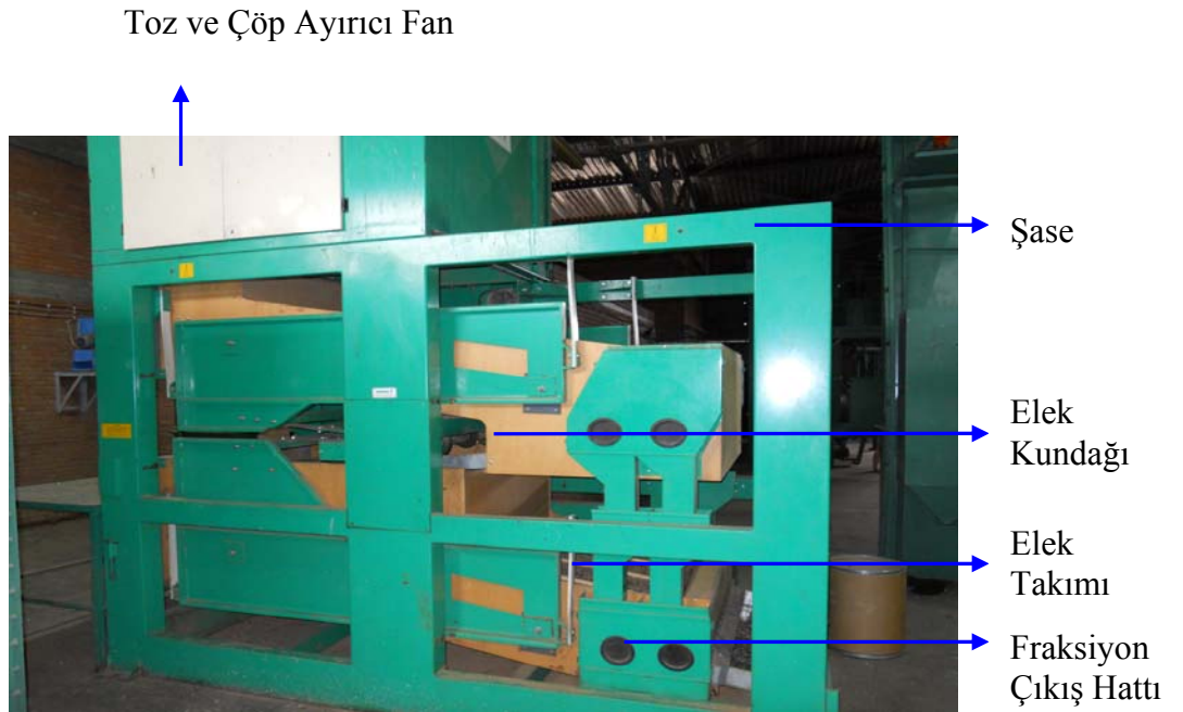
Şekil 1.17 Şeker pancarı tohumluğunun hazırlanması sürecinde kullanılan eleme düzeni
