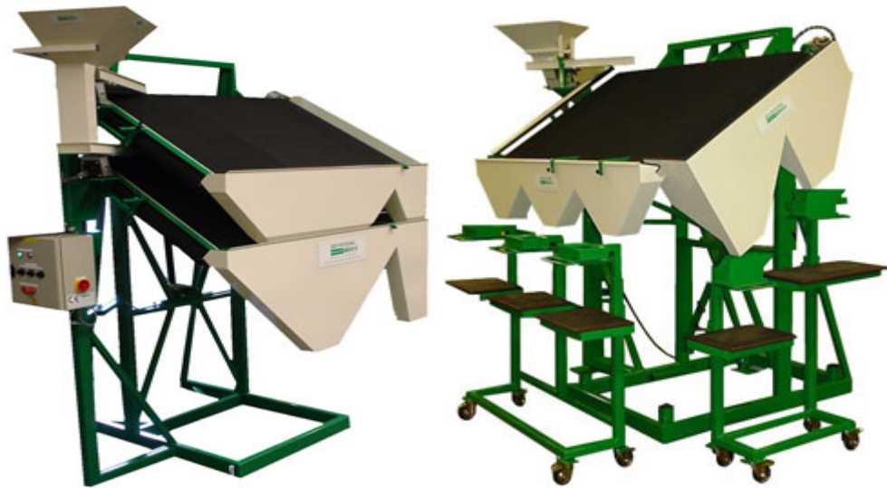
Şekil 1.27 Eğimli bant yüzeyin iki farklı kullanım şekli (Anonymous 2011)
