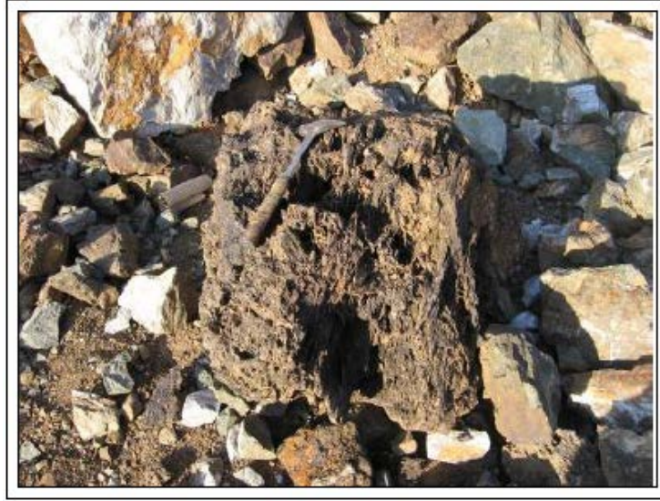
Şekil 7.12 Biksibit, simitsonit, hematit ve silis içeren geç evre cevher örneği
