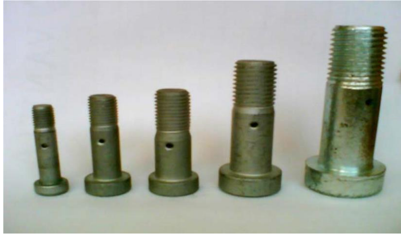
Şekil 1.9. Civata tipleri (dişsiz kısmında delik açılır)
