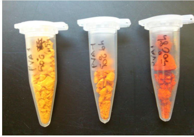
Şekil 8.3. P(AN-VAc) kopolimerinin alkolic yapıldıktan sonraki görüntüsü; alkolicden 4.5 saat sonra (solda), 6 saat sonra (ortada), 8 saat sonra (sağda)
