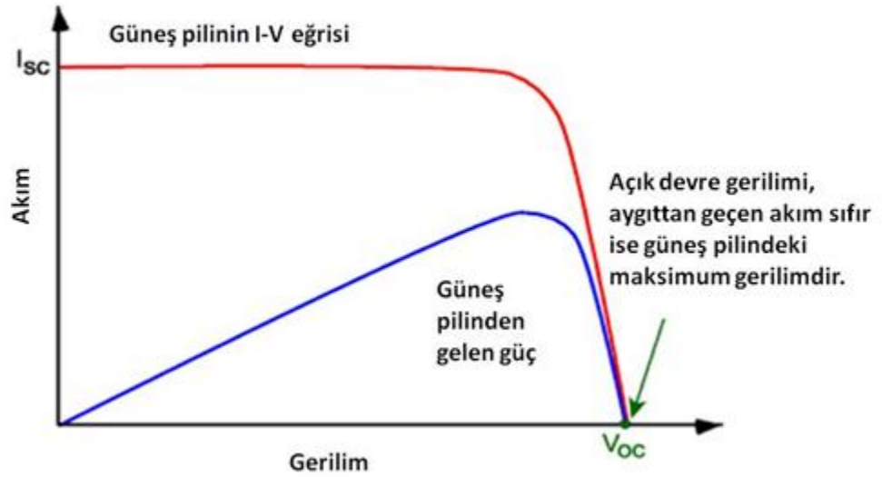
Şekil 3.5. Güneş pilinin I- V eğrisindeki açık devre gerilimi.
