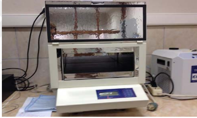
Şekil 10. Lasercomp Fox-314 ısıl iletkenlik cihazı
