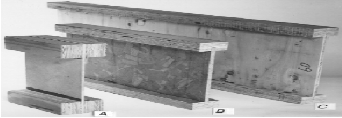
Şekil 8. Prefabrik I.krişlerinin uç kısımlarında LVL'nin kullanımı A) Panel kısmı sert lif levha. B) Panel kısmı OSB. C) Panel kısmı kontrplak (Woodhand book-Glued Structural Members, FPL)
