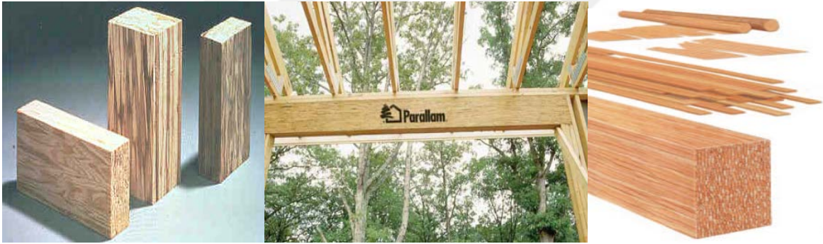
Şekil 1. PSL örnekleri ve uygulama alanları
