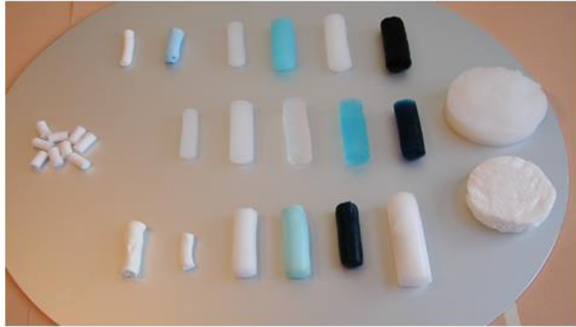
Şekil 2.8.b. Kriyojellerin farklı formları. Kriyojeller farklı formlar oluşturabilirler, boncuklar, monolitik kolonlar, diskler v.b.
