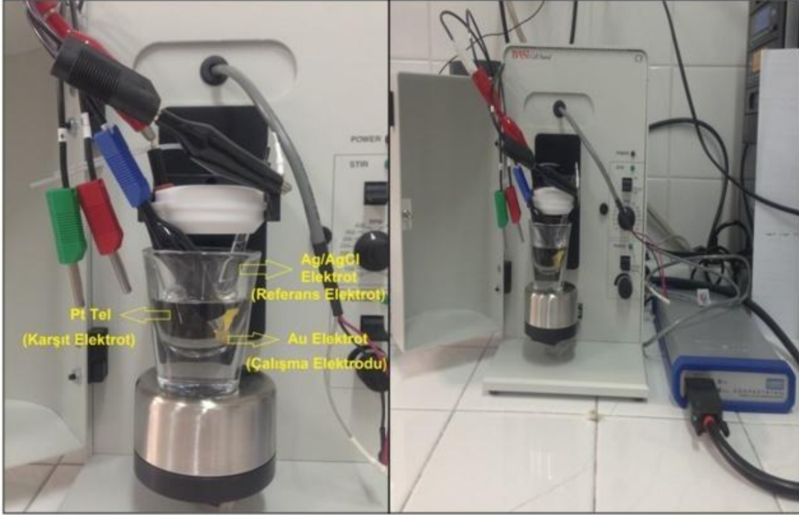
Şekil 3.1. Hücre sistemi (solda) ve hücre sisteminin bağlı olduğu, verilerin okunduğu potansiyostat cihazı (sağda).
