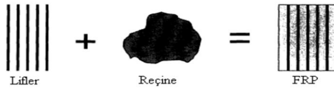
Şekil 1.6. Lifli polimer kompozit malzeme formu (Tuakta C., 2005)
