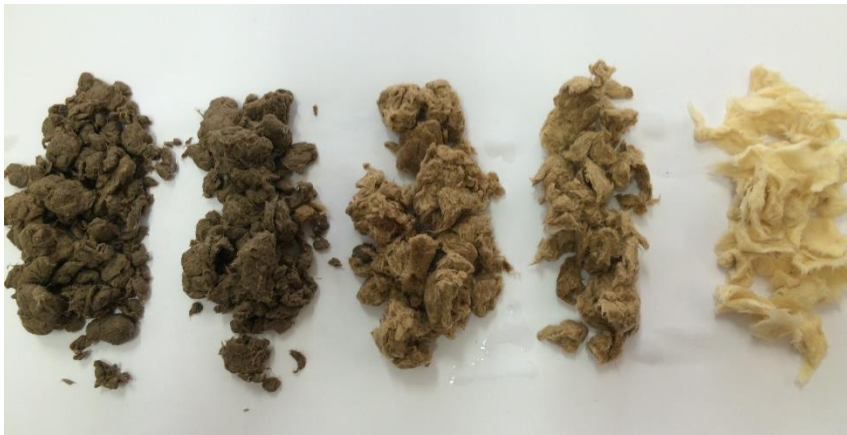
Şekil 1. Kraft hamurunun kademeli olarak ağartılması sonucunda oluşan renk değişimi
