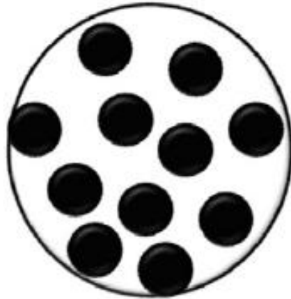
Şekil 2.14. Polimerik küre içerisinde homojen dağılmış manyetik partiküller [6]
