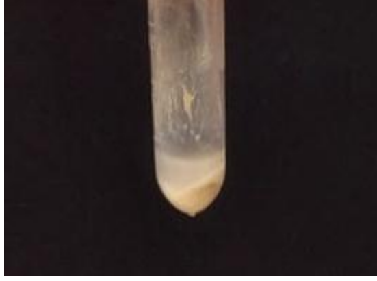
Şekil 4.6. m-PGMA mikrokürelere manyetik alanda adsorpsiyon ortamından ayrılması
