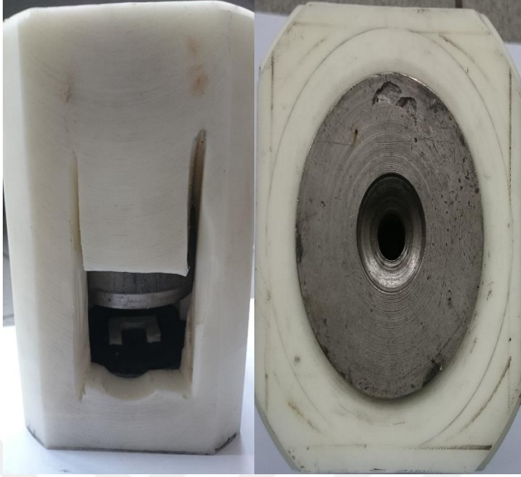
Şekil 31. Eu-152 kaynaklı deney geometrisinde kullanılan kolimatör sistemi
