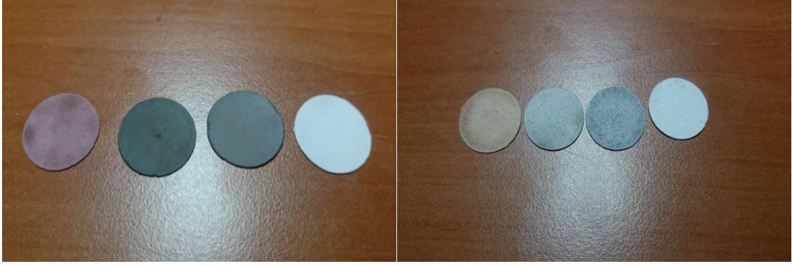
Şekil 23. EDXRF Sistemi için Hazırlanan Standart Numuneler ve Tez Numuneleri
