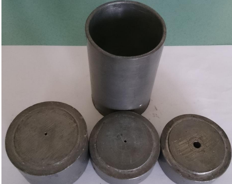
Şekil 32. Am-241 kaynaklı deney geometrisinde kullanılan kolimatörler
