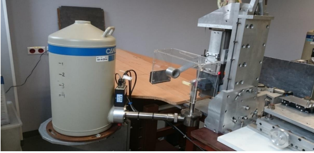
Şekil 25. Üç Boyutlu İkincil Hedefli Harici X-Işını Tüpü Tabanlı EDXRF Sistemi (AGH UST Krakow, Polonya)
