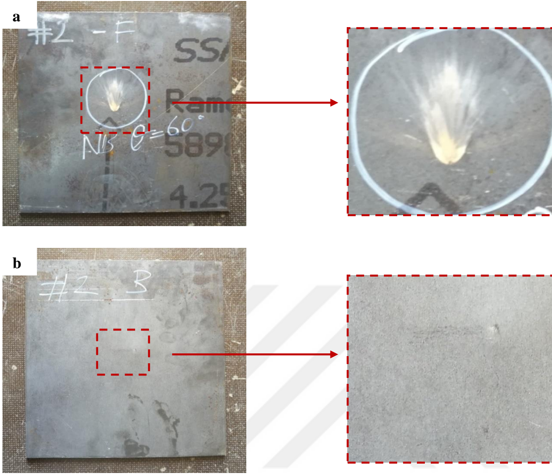
Şekil 2.15. 2 no'lu plakanın atış sonrası (a) ön, (b) arka yüzey görüntüleri
