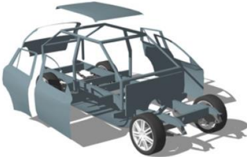
Şekil 1.34. Ramor zırh çeliklerinin araç üzerinde kullanımı [68]
