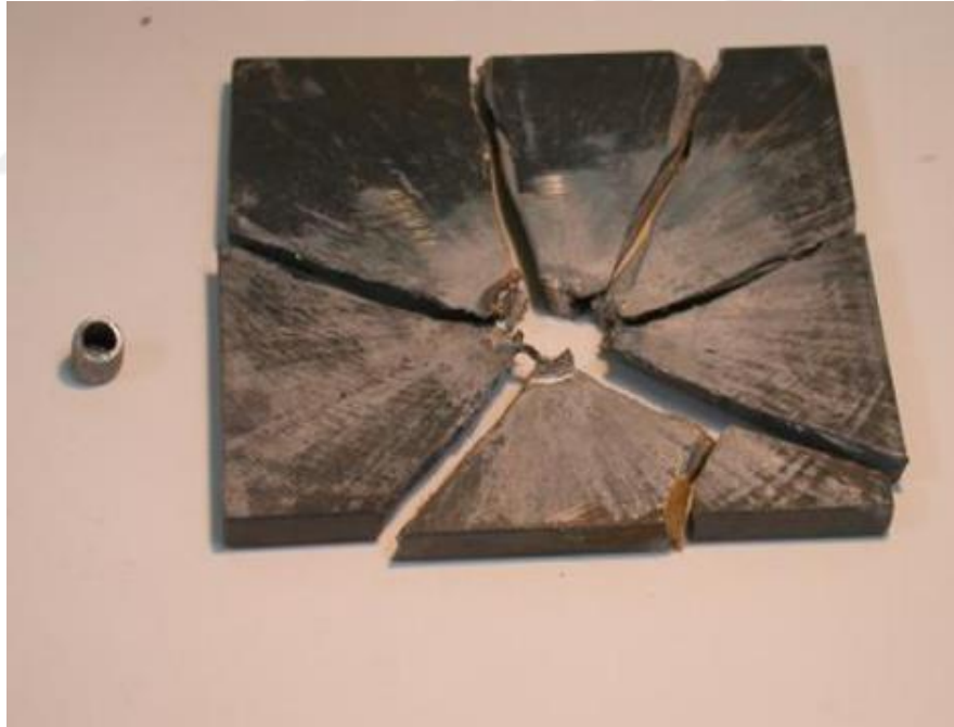
Şekil 1.32. 50CrV4 yay çeliğinin (60 HRC) balistik test sonrası görüntüsü [66]
