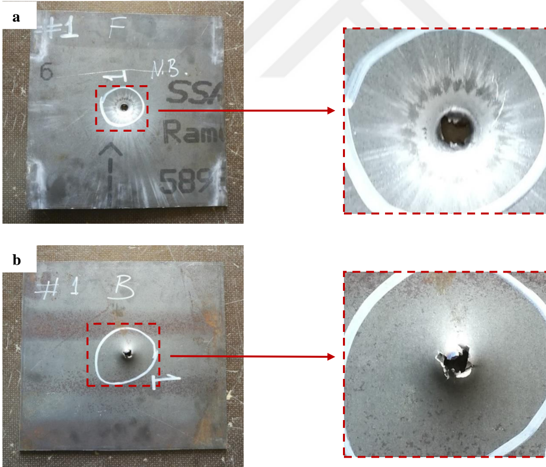
Şekil 2.13. 1 no'lu plakanın atış sonrası (a) ön, (b) arka yüzey görüntüleri
