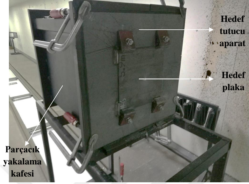
Şekil 2.12. 0° derece testte kullanılan plaka ve hedef tutucu aparatın görünümü
