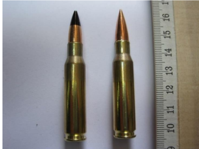
Şekil 2.11. Balistik testlerde kullanılan 7.62x51 mm NATO AP (solda) ve 7.62x51 mm NATO Ball (sağda) fişekleri
