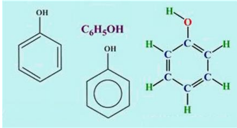
Şekil 2.1. Fenolün kimyasal yapısı
