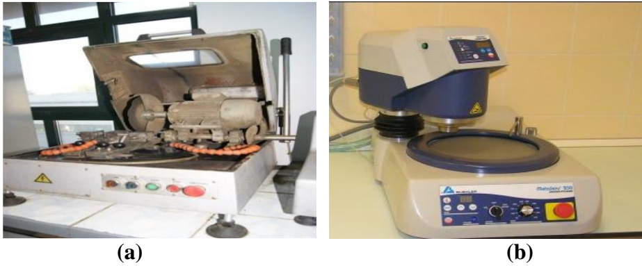
Şekil 2. 7. (a) Kesme cihazı (b) Otomatik zımparalama ve parlatma cihazı (c) Bakalit cihazı
