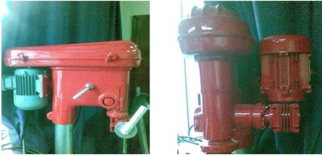
Şekil 3.11 Yukarı aşağı hareketi ve salınım hareketini üreten motorların görünümü
