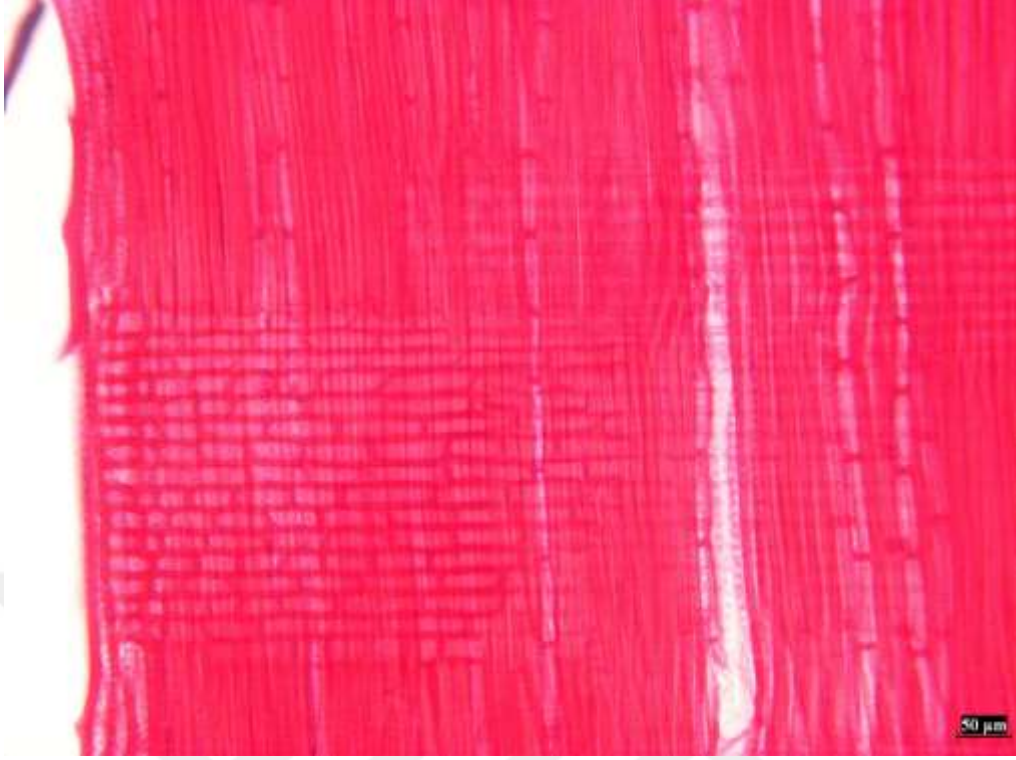
Şekil 27. Quercus petraea subsp. iberica odunundan radyal kesit (50 µm),
