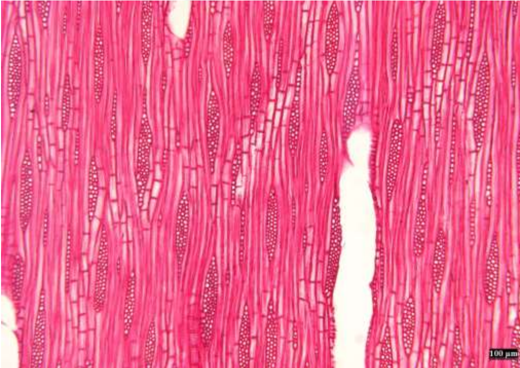
Şekil 36. Juglans regia L. odunundan teğetsel kesit (100 µm), üniseri, biseri ve mutliseri özışınları
