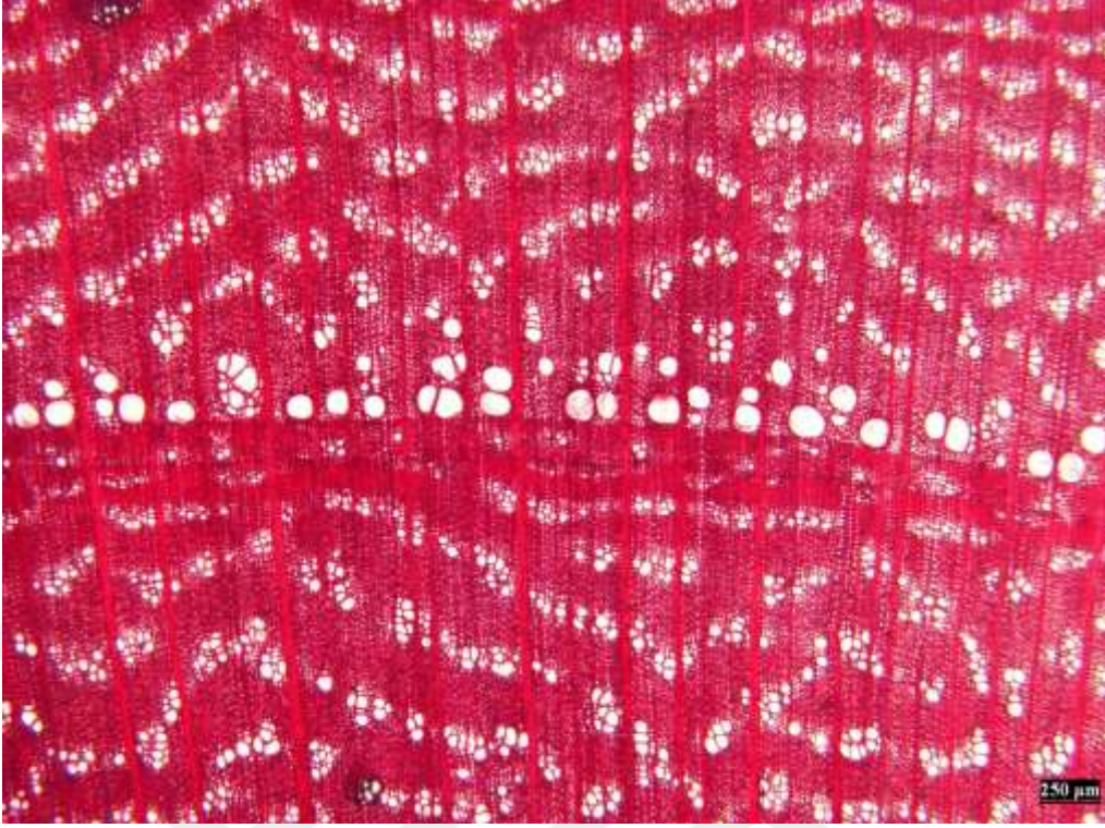
Şekil 17 . Ulmus glabra odunundan enine kesitte halkalı traheli odun (250 µm)
