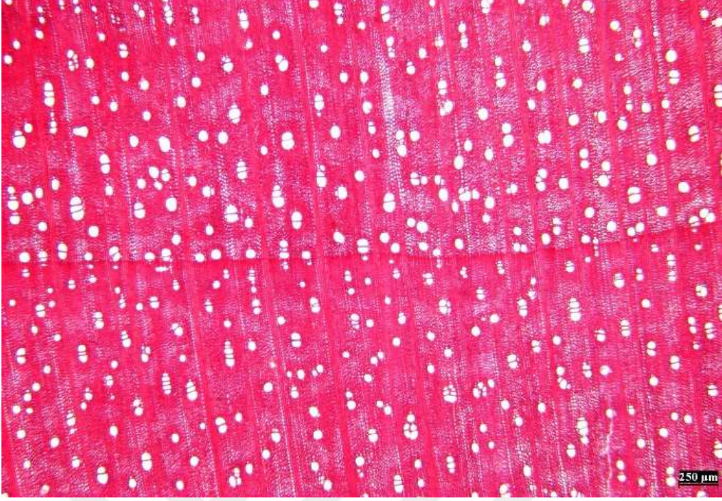
Şekil 1. Acer cappadocicum odunundan enine kesit (250 µm)
