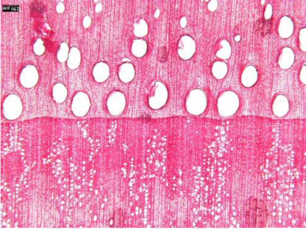
Şekil 29. Castanea sativa odunundan enine kesit (250 µm), halkalı traheli odun
