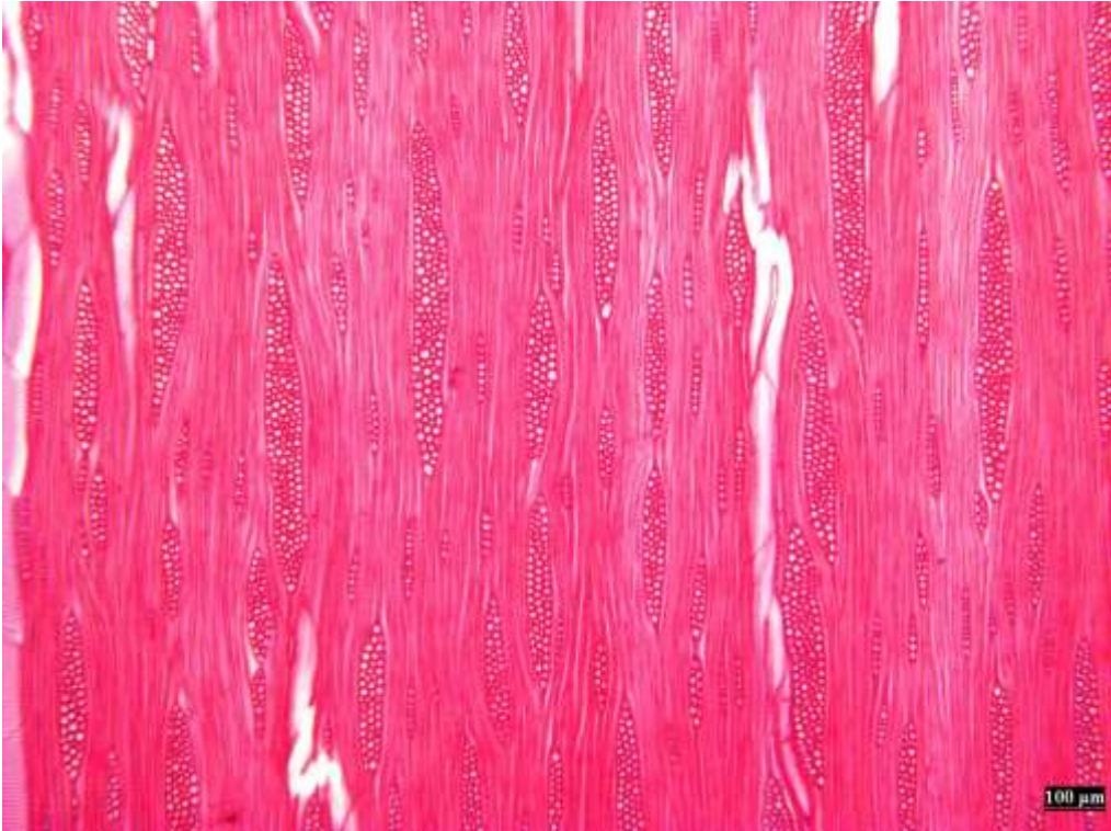
Şekil 4. Acer cappadocicum odunundan teğetsel kesitte üniseri, biseri ve multiseri özışınları (100 µm)
