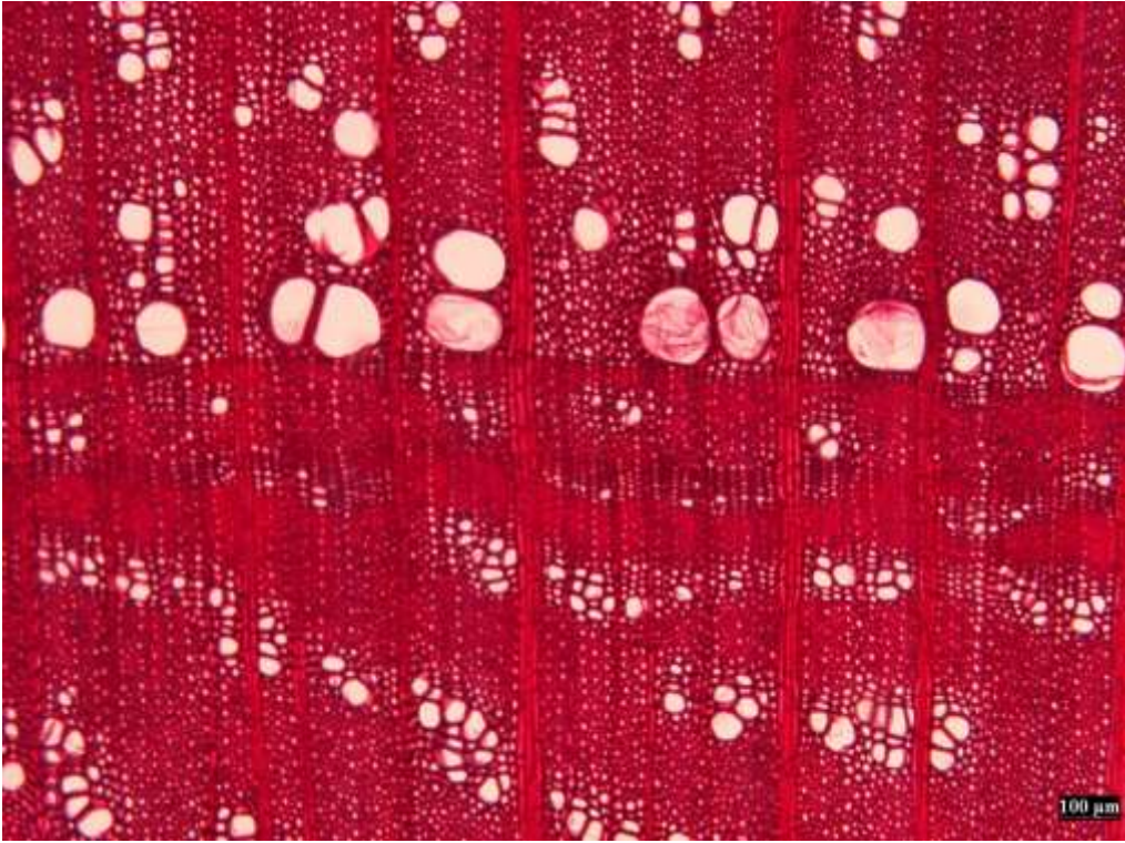
Şekil 18. Ulmus glabra odunundan enine kesit (100 µm)
