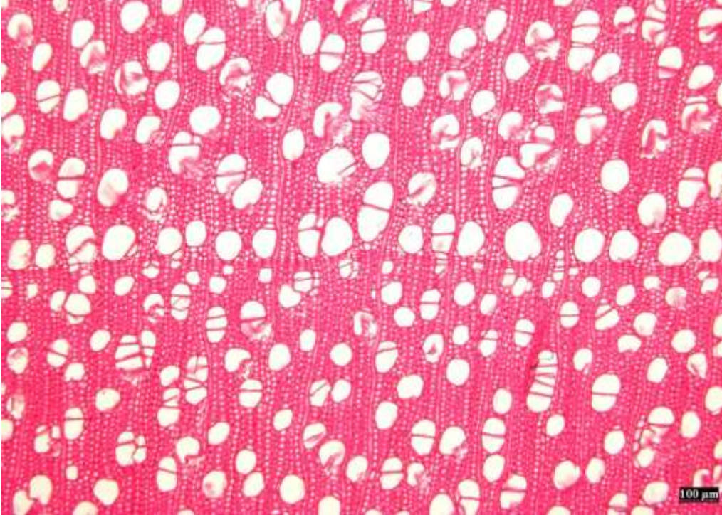
Şekil 10. Salix caprea odunundan enine kesit (100 μm)
