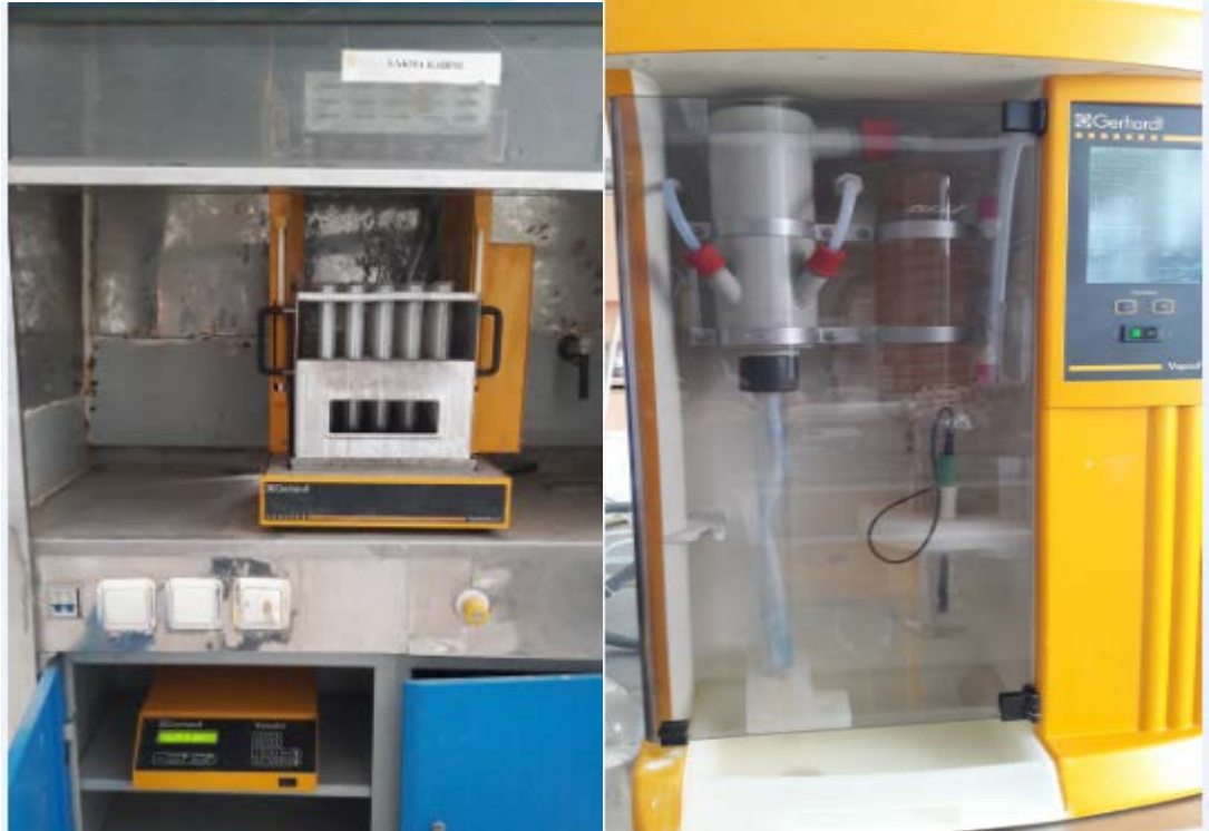
Şekil 3.2. Ham protein yaş yakma ve destilasyon üniteleri cihazı
