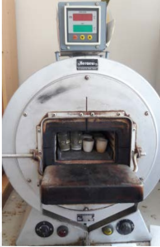
Şekil 3.1. Kül fırınında ham kül tayini
