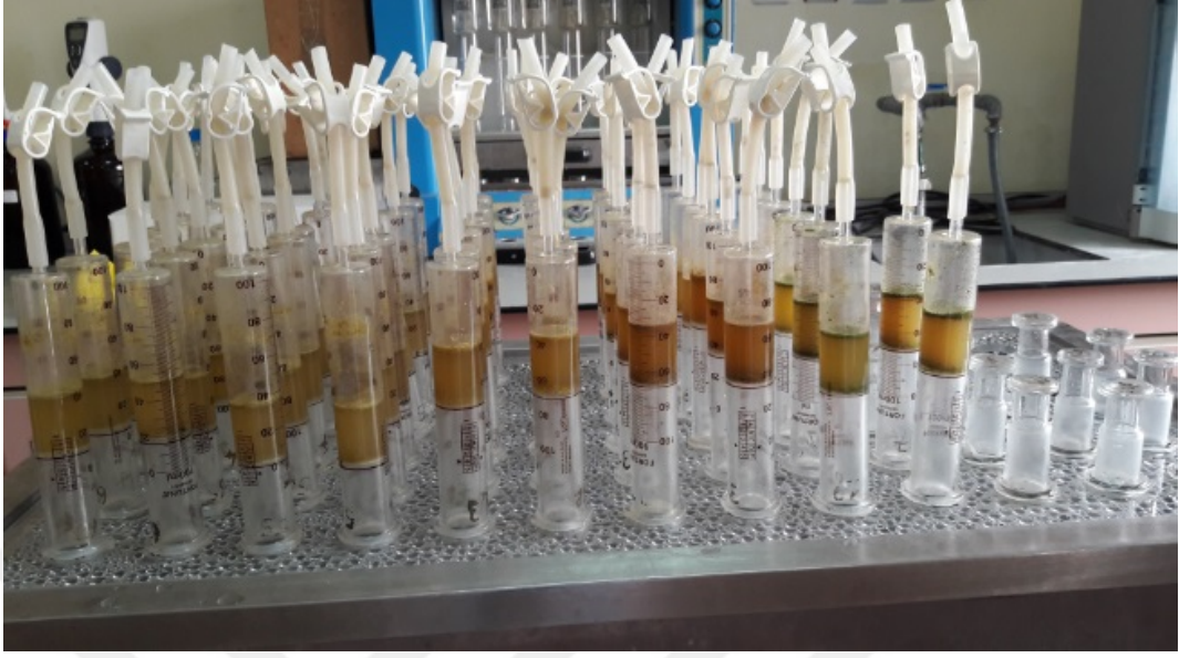
Şekil 3.5. İnkübasyonun 24. saatinde gaz miktarlarının okunması
