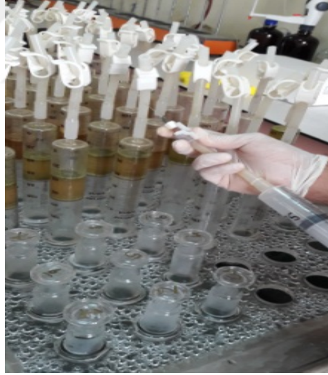
Şekil 3.6. Metan miktarlarının belirlenmesi amacıyla inkübasyondan sonra şırınga içerisindeki gazların transferi
