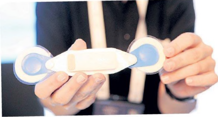
Şekil 26. Arçelik markasının geliştirdiği mobil ekg cihazı [55]
