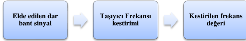
Şekil 1-4 Taşıyıcı frekansı kestirimi bloğunun girdileri ve çıktıları
