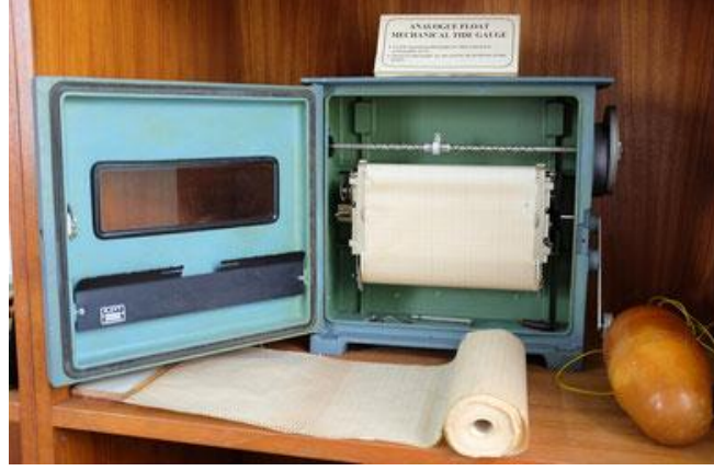
Şekil 2. Analog deniz seviyesi ölçüm sistemi
