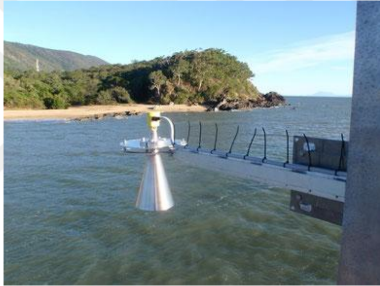
Şekil 3. Radar deniz seviyesi ölçüm sistemi
