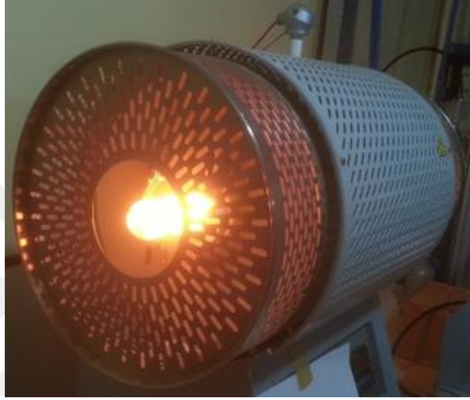
Şekil 3.3. Tabletın tüp fırında sinterlenmesi
