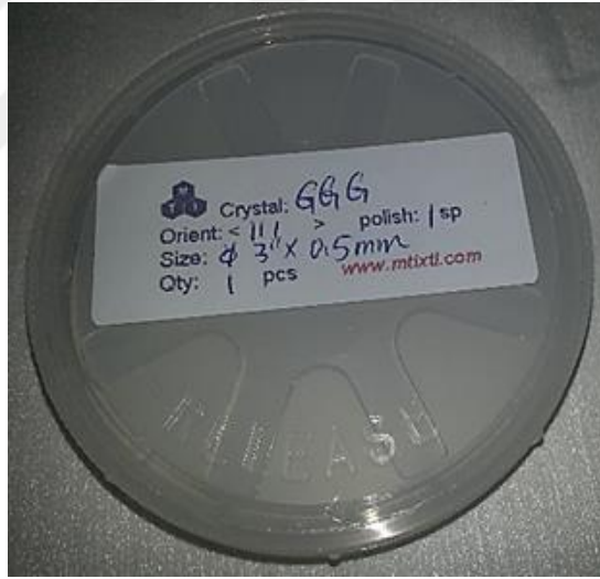
Şekil 3.5. Satın alınan \langle 111 \rangle tek kristal GGG wafer
