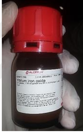
Şekil 3.1. Kullanılan %99,9 saflıkta YIG nanotoz
