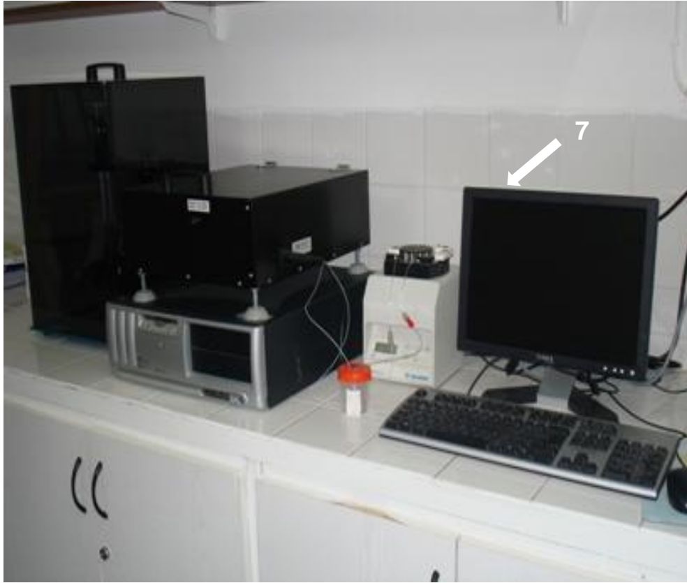
Şekil 3.4. GenOptics SPRiLab sistemi: (1) Lazer kaynađı; (2) açı ayarlanmasında kullanılan gonyometre; (3) optik yönlendirici lensler; (4) akış hücresi; (5) SPR çip; (6) CCD kameralı dedektör ve (7) bilgisayar birimi.
