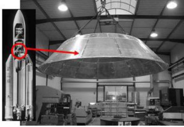
Şekil 1.14. Bir rokette kullanılan alüminyum köpükten yapılmış koni biçimindeki prototip [33].
