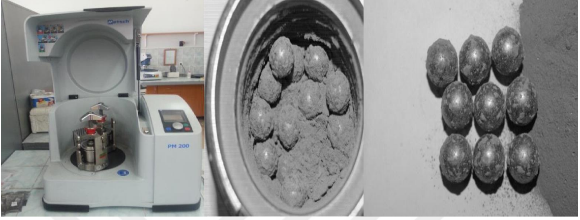
Şekil 2.3. Bilyeli değirmen, öğütücü kap ve bilyeler
