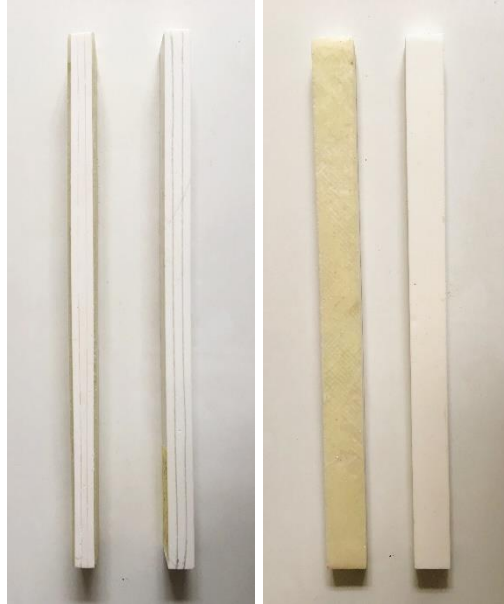
Şekil 3.7. Sandviç ve tabakalı yapıdaki burkulma numunelerinin yan ve üst görünümü
