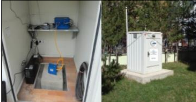
Şekil 29. İvme-ölçer istasyonların iç ve dış görünümü
