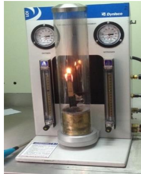
Şekil 4. Dynisco marka LOI cihazı
