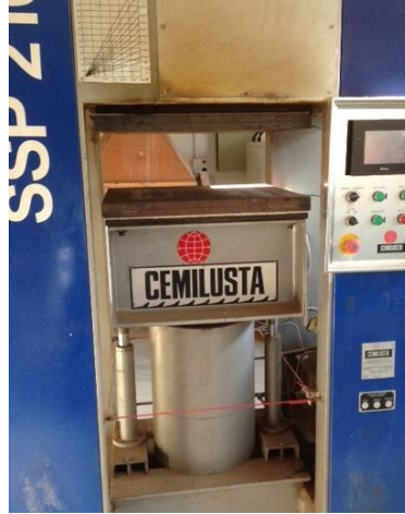
Şekil 2. Levha üretiminde kullanılan tek katlı pres
