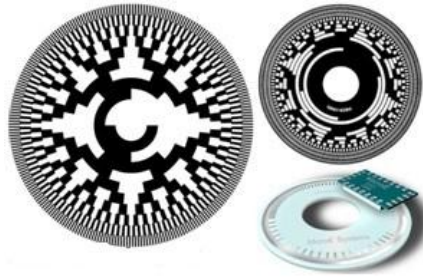
Şekil 4.14: Mutlak enkoder yapıları [39]
