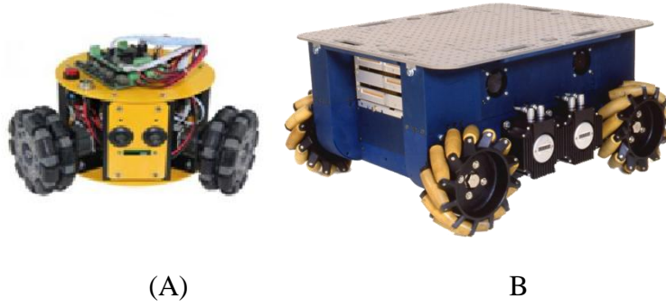
(A) B Şekil 3.9: Çok yönlü platformlar Üç tekerli 90° rulolu (A), Dört tekerli ve 45° rulolu (B) . [29-30]
