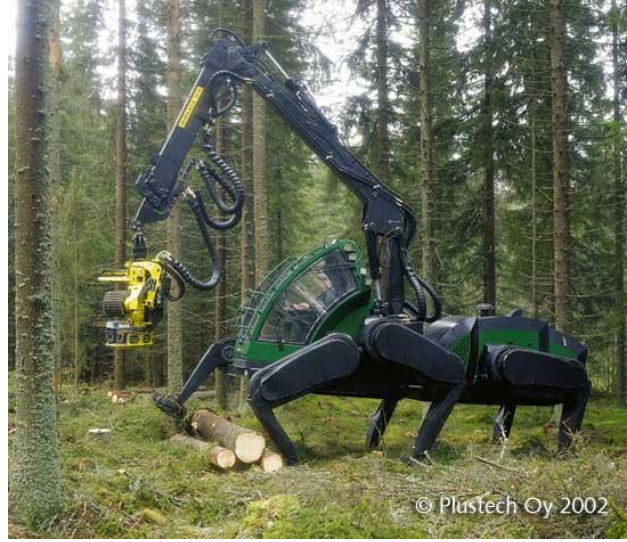
Şekil 1.1 : Plustech ormanlık alandan dışarıya kütükleri taşımak için tasarlanmıştır.[1]
