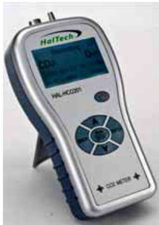
Şekil 3-9 sıcaklık, bağıl nem ve CO 2 ölçen cihaz
