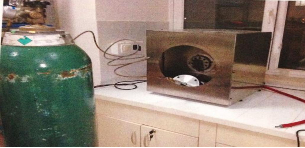
Şekil 3-3 tüp temizleme fırını
