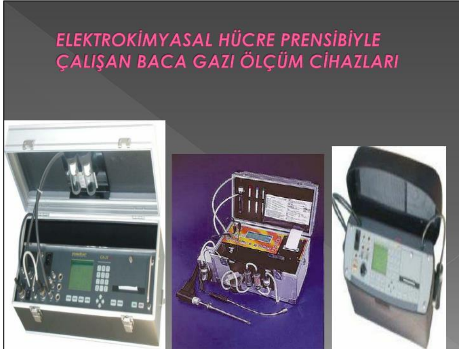
Şekil 4. Elektrokimyasal hücre prensibiyle çalışan ölçüm cihazı
