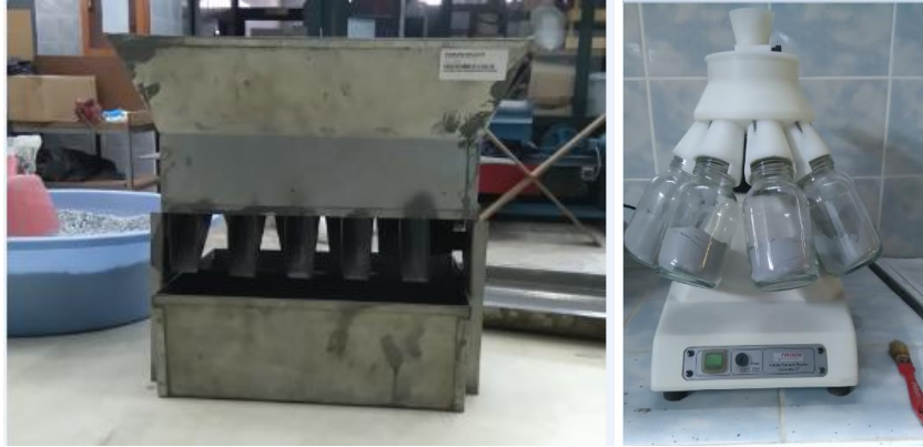
Şekil 20. Numune bölmede kullanılan ızgaralı bölücü (solda) ve otomatik numune bölücü (sağda)
