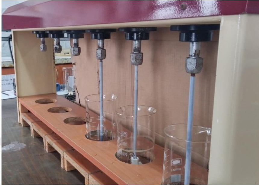
Şekil 23. Dijital hız göstergeli çoklu mekanik karıştırıcı liç düzeneği
