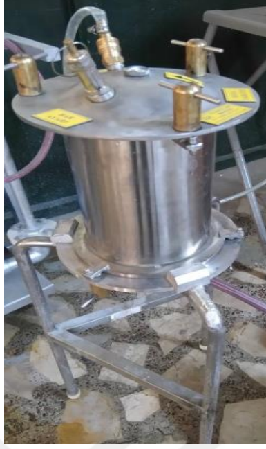
Şekil 25. Liç testleri sonunda katı/sıvı ayırımında kullanılan basınçlı filtre ekipmanı
