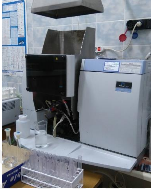
Şekil 24. Çözeltiden metal analizlerinin gerçekleştirildiği atomik absorpsiyon spektrometresi (Perkin Elmer AAnalyst 400)
