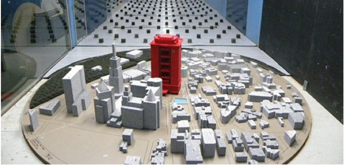
Şekil 17. Örnek bir rüzgâr tüneli deney düzeneği. (URL-7, 2019)
