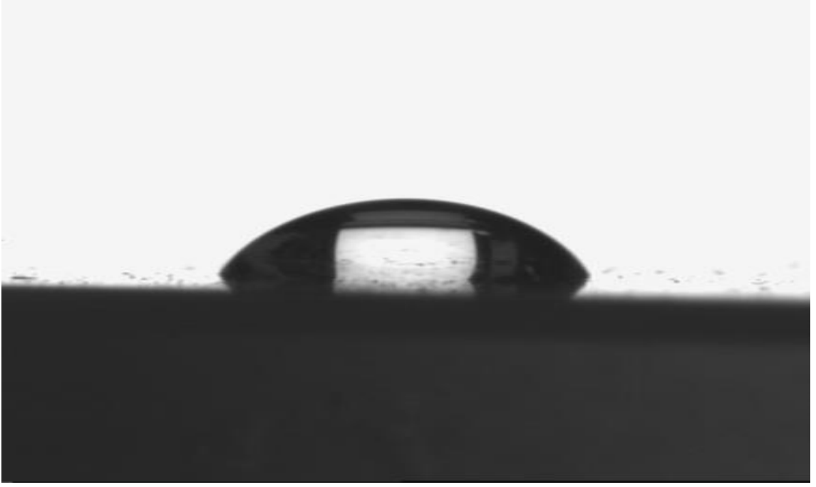
Şekil 4.8. PAAm SPR biyosensör yüzeyinin temas açısı ölçüm fotoğrafı.
