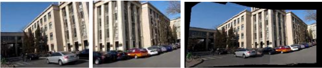
Şekil 3. Eşleştirilmiş resimlerden panorama resminin oluşturulması [6]
