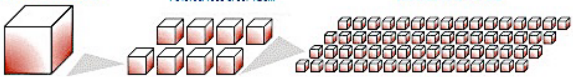
Şekil 2. 2. Aynı malzeme miktarı için yüzey alanının artışı
