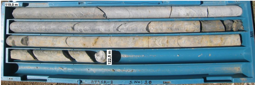
Şekil 4.3. AT2SK-3/ km: 2+518, Kuytu formasyonu (119,0-122,5 m)
