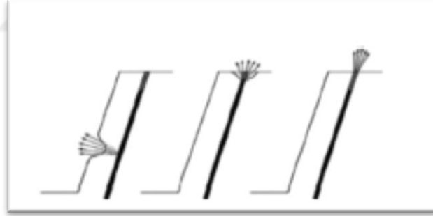
Şekil 4.1. Açık işletmelerde oluşan kaya fırlama mekanizması (Dhekne, 2015)
