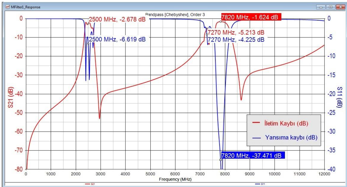
Şekil 3.18. 2400-2600MHz bandında üçüncü dereceden tarak dişli filtrenin merkez frekansdaki rezonatörlerin elektriksel uzunluğu \theta_0 75^\circ iken gerçekleşen filtre tepkisi
