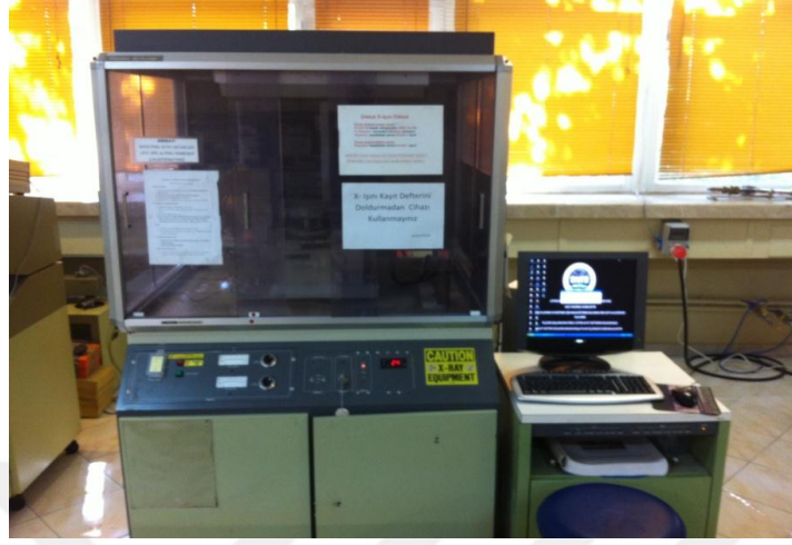
Şekil 3.5: Hacettepe Üniversitesi Süperiletkenlik ve Nanoteknoloji Grubu laboratuvarında bulunan XRD ölçümlerinin yapıldığı sistem.
