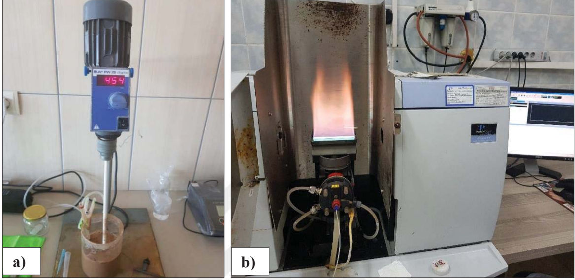
Şekil 2.11. (a) Liç ünitesi (b) AAS alev teknolojisi ile metallerin analizi
