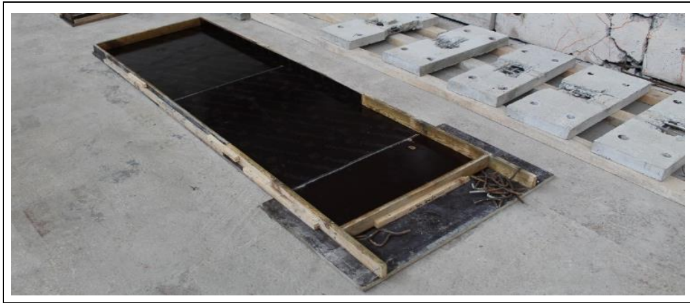
Şekil 99. Eğilme deney elemanlarının üretimi için hazırlanan kalıba ait görsel.
