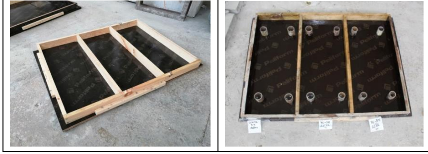
Şekil 76. Ön deney elemanlarının üretimi için hazırlanan kalıplara ait görseller.
