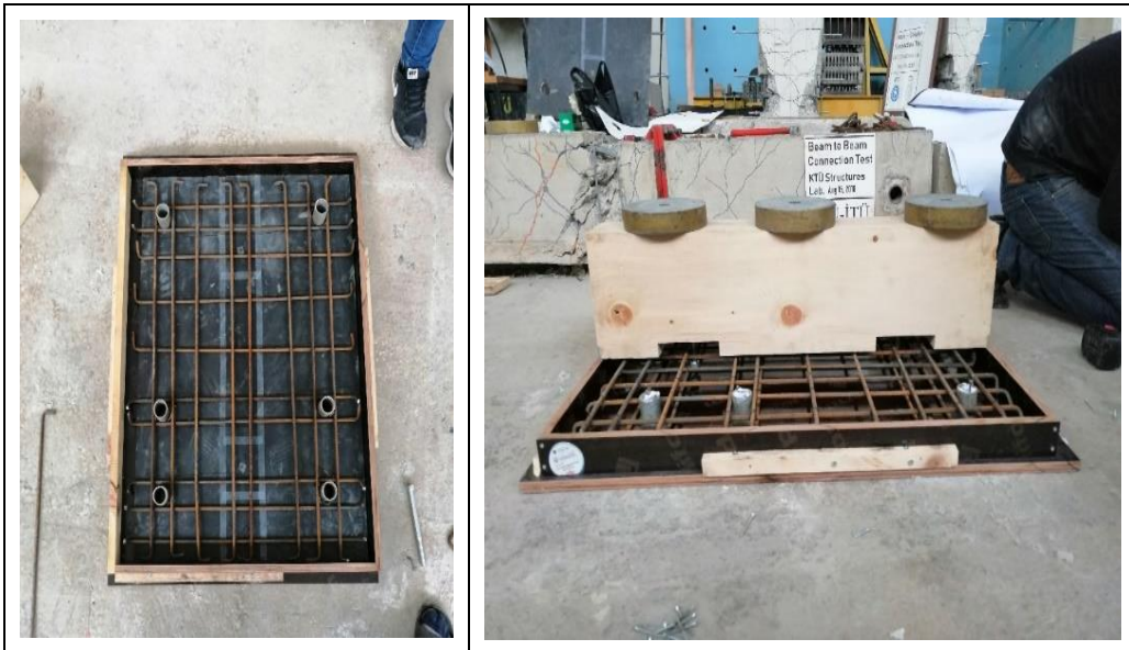
Şekil 94. Donatı çubuklarının yerleştirilmesine ait görseller.
