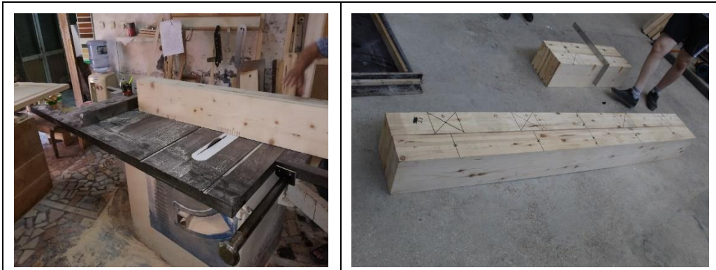
Şekil 97. Çentikli/yapay çentikli bağlantılar için Lamine ahşap kirişlerin hazırlanması.
