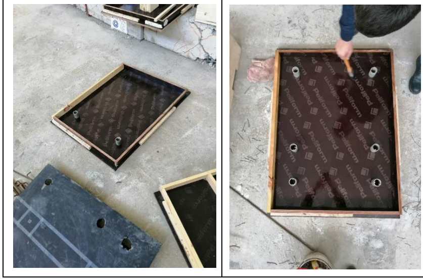
Şekil 93. İtme deney elemanlarının üretimi için hazırlanan kalıplara ait görseller.
