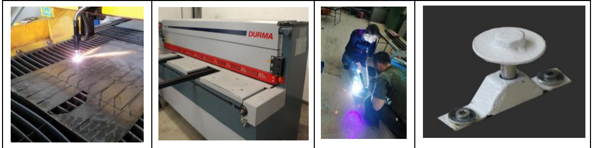
Şekil 73. Yapay çentik imalat adımları; a) kesme, b) bükme, c) kaynaklama ve d) birleştirme.
