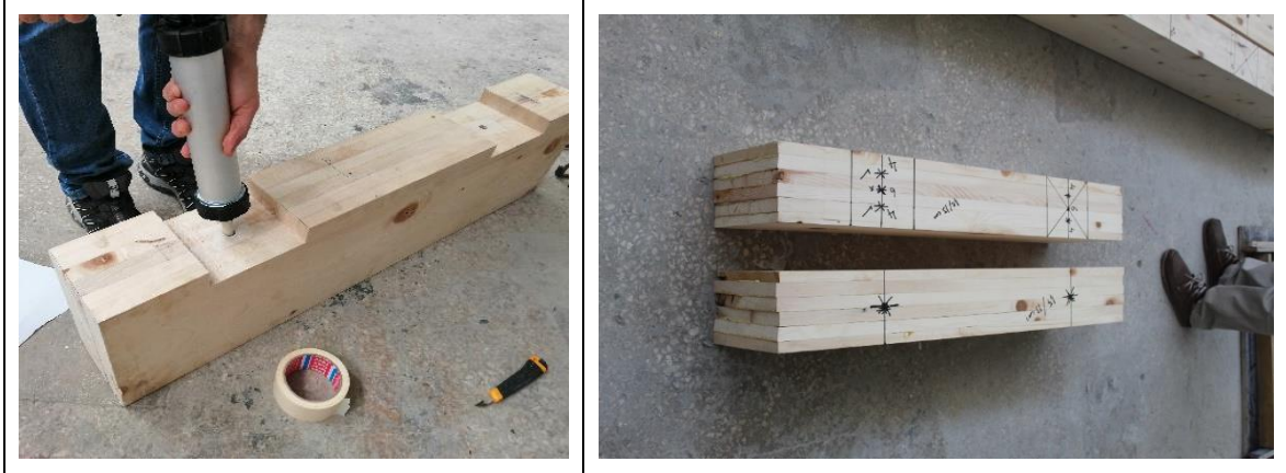
Şekil 90. Çentikli ve yapay çentikli bağlantılar için Lamine ahşap kirişlerin hazırlanması.
