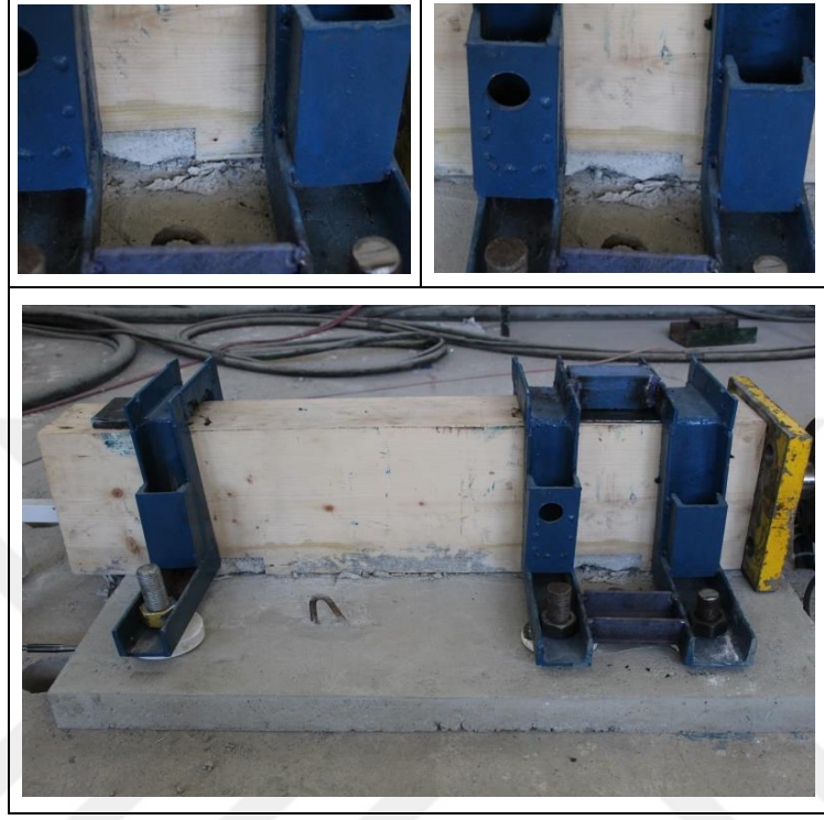
řekil 111. Beton plak ve beton entik arasında oluřan sıyrılma.
