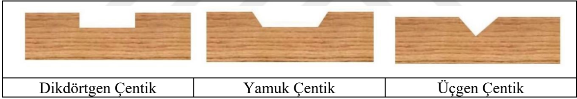
Şekil 32. Ahşap-Beton Kompozit sistemlerde yaygın kullanılan çentik şekilleri[18].
