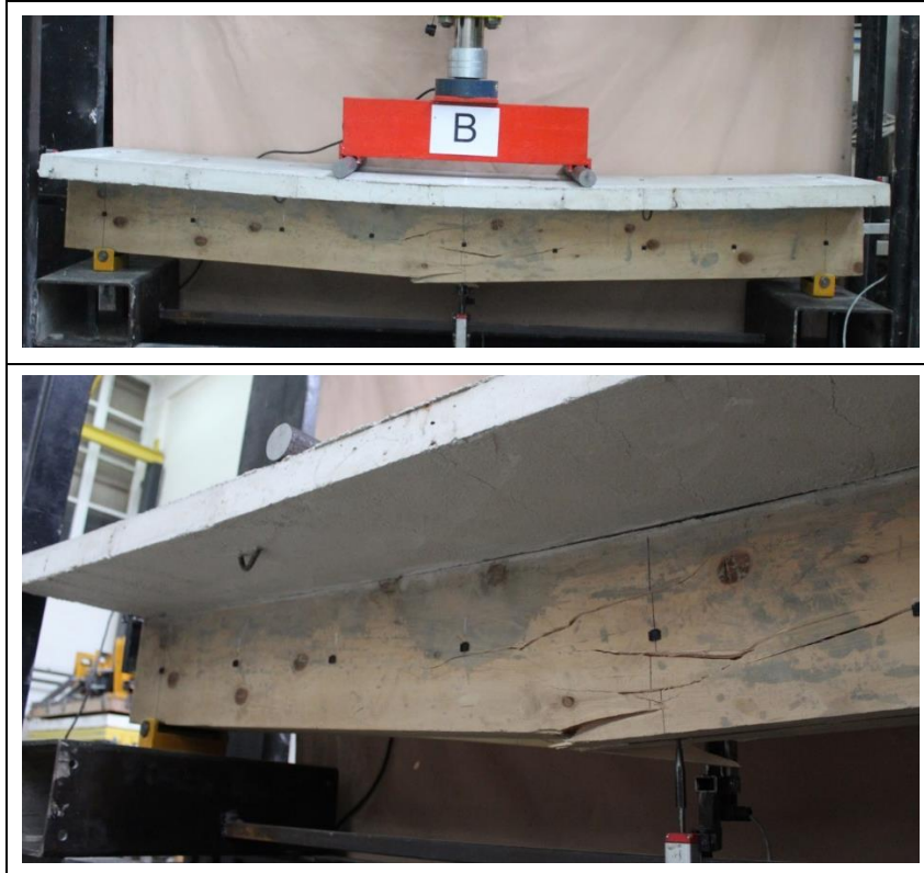
Şekil 125. B-1 deney elemanının taşıma gücünü kaybettikten sonra görünümü.
