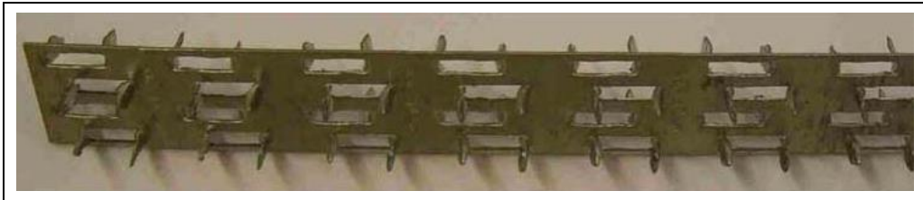
Şekil 22. Jorge (2005) tarafından test edilen dişli metal tipi bağlantı elemanı[43].
