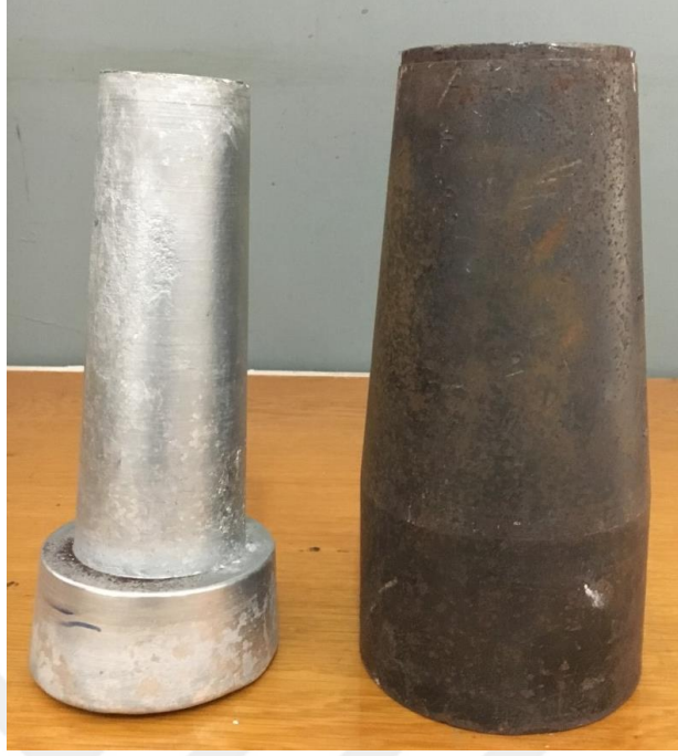
Şekil 6. Kalıptan çıkarılmış döküm parçasının (ingot) ve kalıbın fotoğrafı
