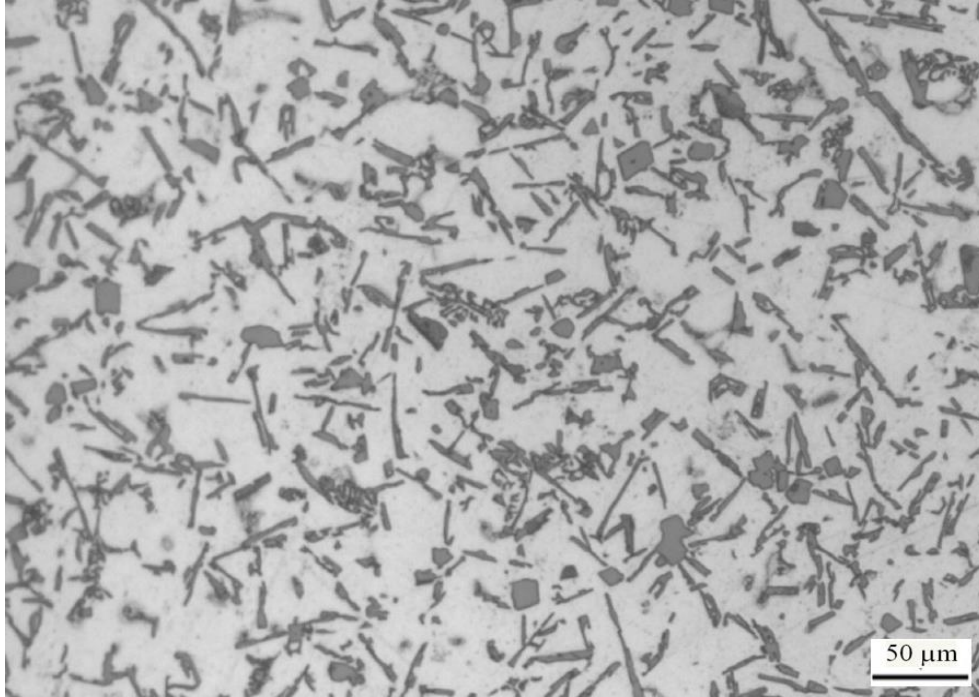
Őekil 35. Al-12Si-3Cu-2Zn-0,5Mn alařımının dklmř durumdaki iyapısı
