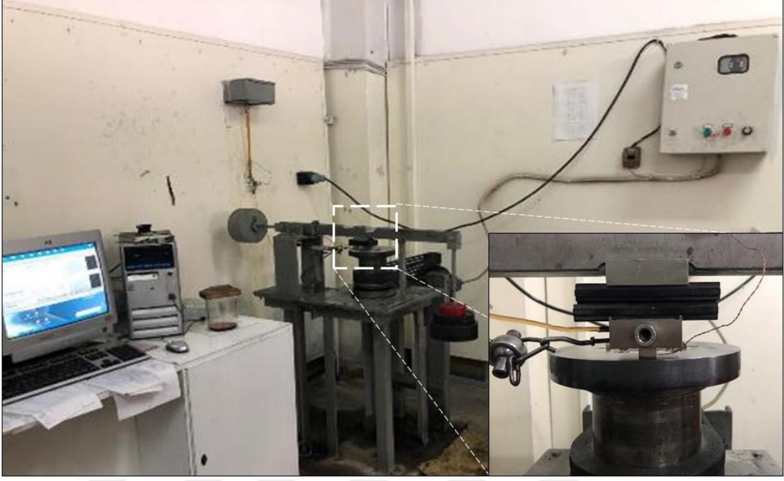
Şekil 15. Blok-disk esaslı sürtünme ve aşınma deney düzeneğinin ve test bölgesinin fotoğrafı
