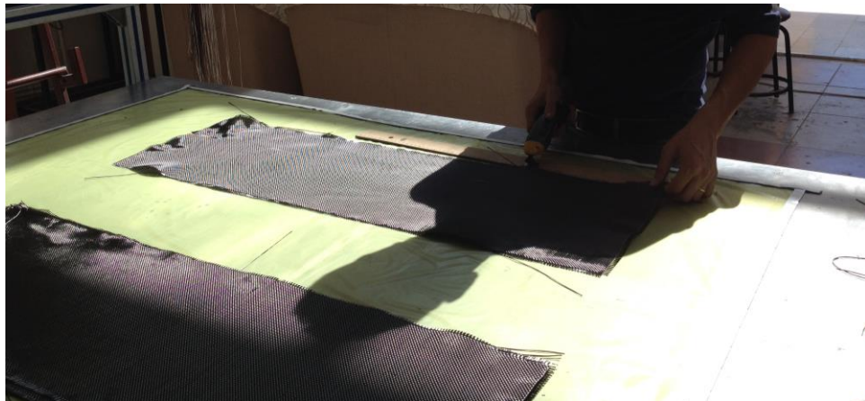
Şekil 3.5. Karbon elyafın tezgâha yerleştirilmesi
