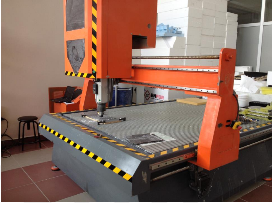
Şekil 3.12. CNC Freze tezgâhında numunelerin kesilmesi
