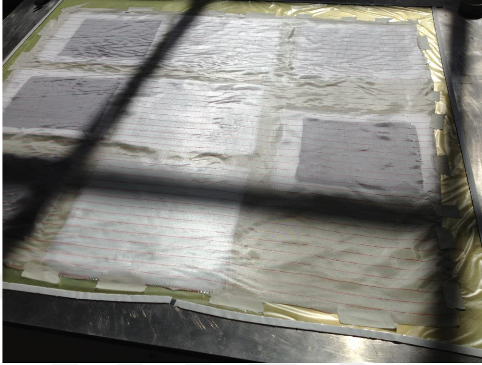
Şekil 3.6. Farklı istiflenme şekillerine sahip numunelerin hazırlanması
