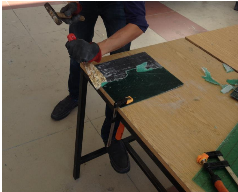
Şekil 3.11. Üretilmiş olan kompozit malzemenin difüzyon filesinden ayrılması
