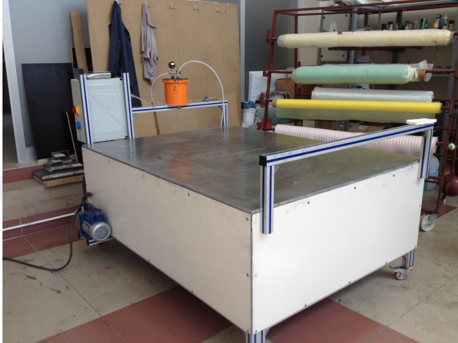
Şekil 3.3. Sıcaklık kontrollü vakum infüzyon üretim ünitesi
