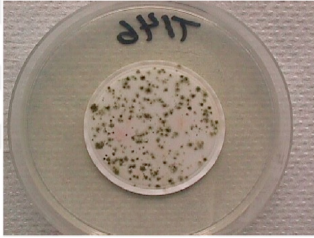
Şekil 2.3. Ağustos 2002 De Alınan Hava Örneğinde Membran Üzerinde Ciddi Bir Mantar Oluşumu Görünmektedir. Bu Örnekte 239 CFU Tespit Edilmiştir [18]
