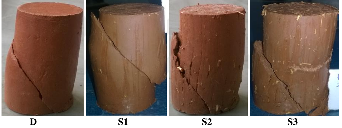
Şekil 4.16. 2 mm uzunluğunda saman katkıli kil numunelerin serbest basınç deneyi sonucu meydana gelen kırılma şekilleri
