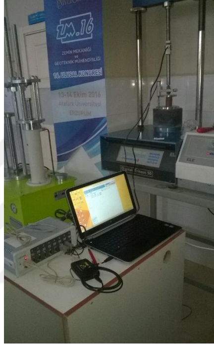
Şekil 3.16. Serbest basınç deneyinin bilgisayar programı aracılığıyla uygulaması
