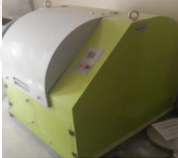
Şekil 3.3. Los Angeles aşındırma cihazı
