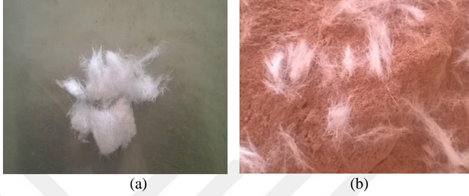
Şekil 3.9. a) Kesilmiş monolif polyester iplik örneği b) Monolif polyester iplik-kil karışım örneği
