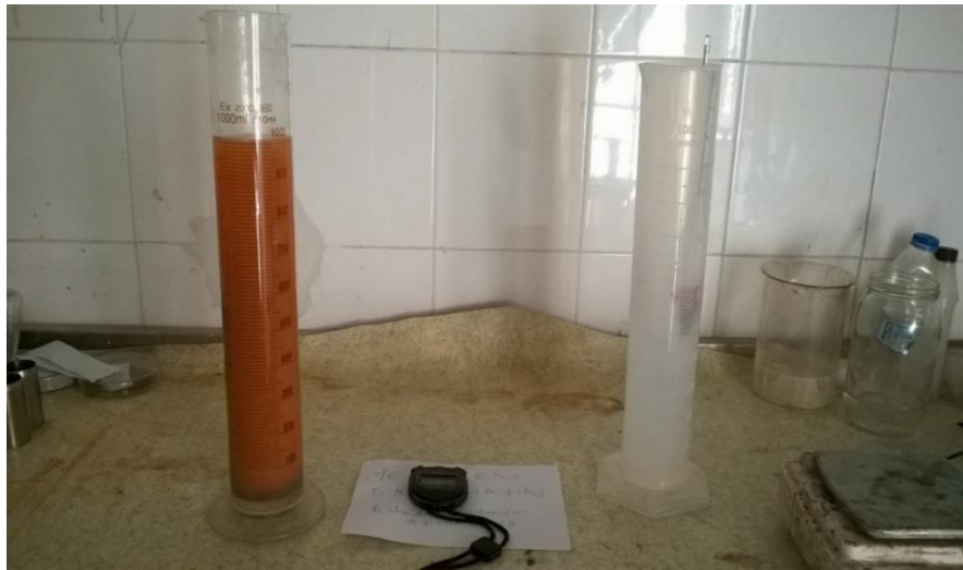
Şekil 3.11. Hidrometre deney okuma düzeneği
