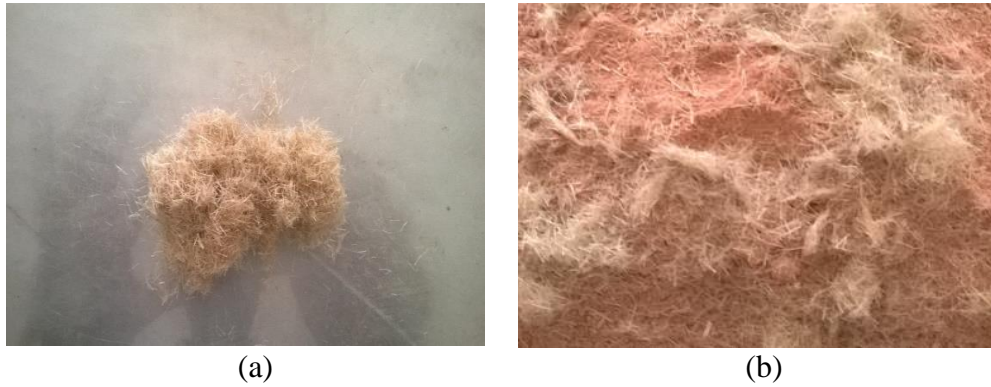
Şekil 3.8. a) Kesilmiş kendir örneği b) Kendir-kil karışım örneği
