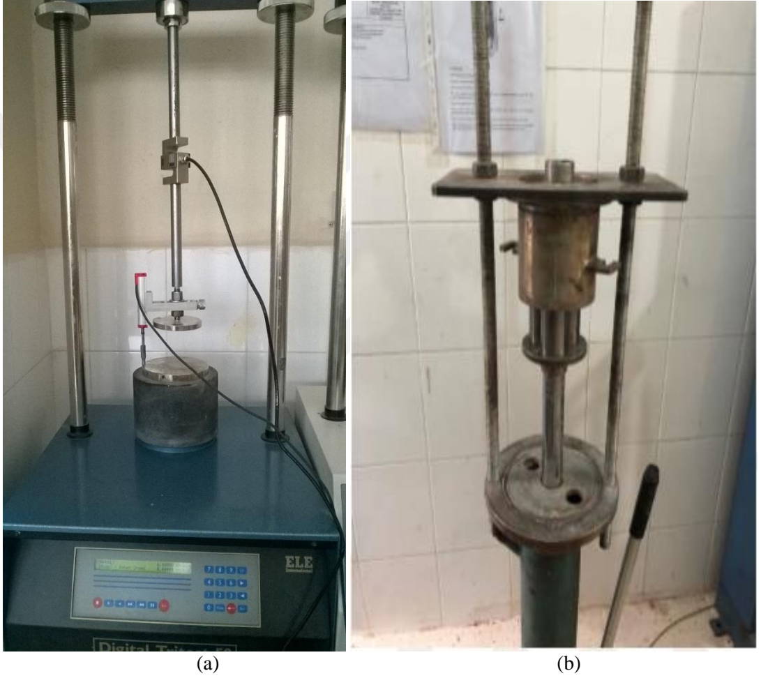
Şekil 3.15. a) Serbest basınç deney aleti b) Hidrolik kriko ile numune çıkarma
