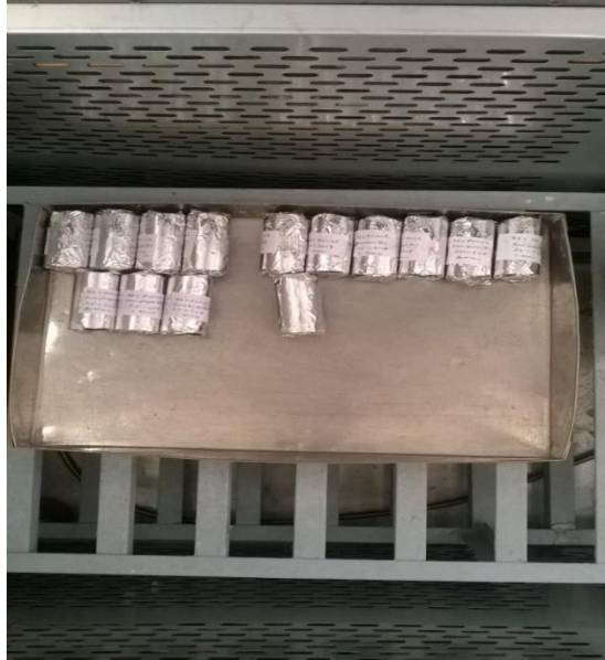
Şekil 3.18. Donma çözülme kabininde folyoya sarılmış numuneler
