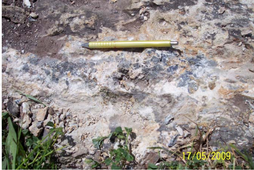
Şekil 5.26 Sülfatlı cevher mineralleri ve aralarında kuvars ve limonit damarları
