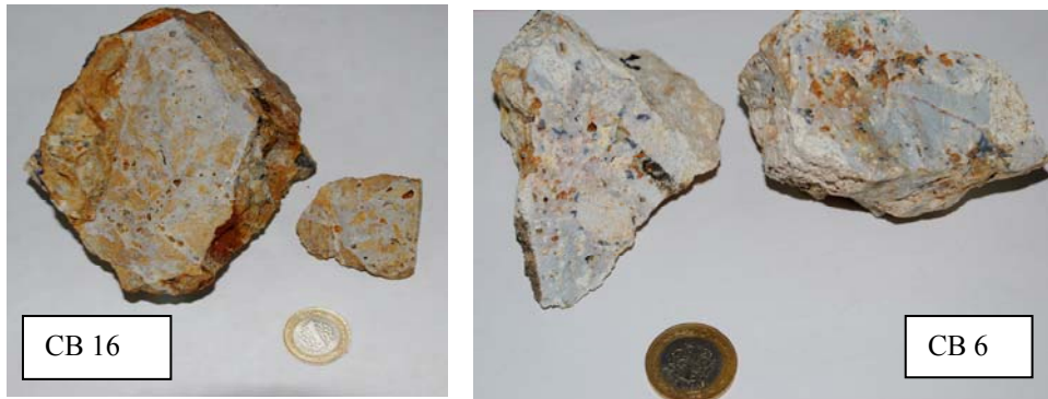
Şekil 5.25 İleri derecede silisleşmiş breşleşmeler gösteren altere bazaltlar
