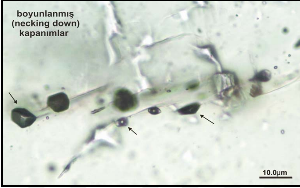
Şekil 7.10 CBY 1-2 nolu örneğin barit kristallerinde yaygın görülen boyunlanmış (necking down) sıvı kapanımlar
