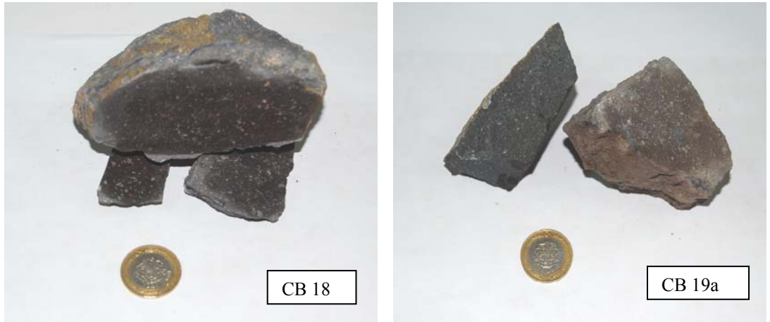
Şekil 5.4 Siyah renkli ve porfirik dokulu az altere bazaltların el örnekleri
