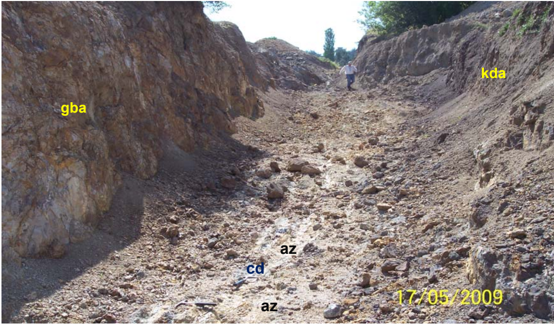
Şekil 5.17 Balcılar sahasının KB kesiminde açılmış yarma. Yarmanın her iki tarafında fay aynası (güneybatı aynası (gba) ve kuzeydoğu aynası (kda)) izlenmektedir. Ortadaki açık renkli kesimde altere zon (az) içinde cevher damarları (cd). (BKB' ya bakış)
