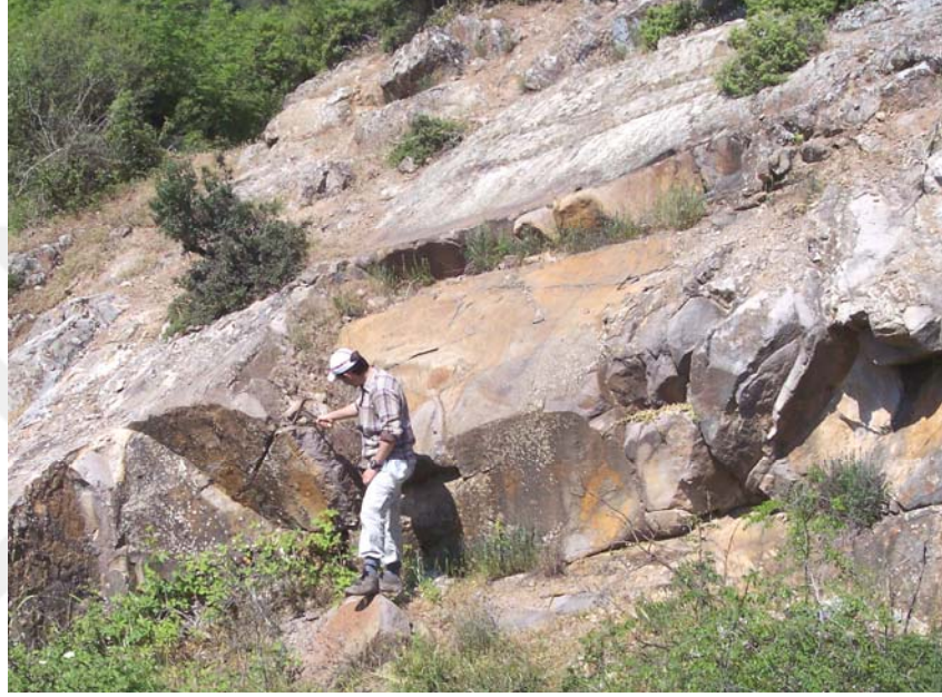
Şekil 5.3 Masif görümlü, gri renkli az altere bazalt yüzleđi. (eski galeri girişinin batısı, K'e bakış)
