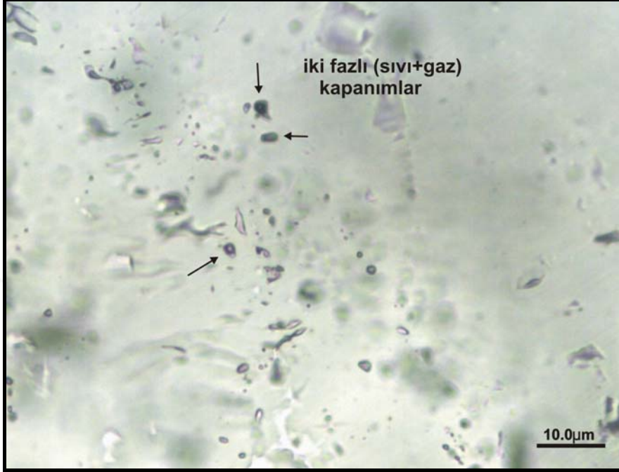
Şekil 7.7 CB 10 nolu örneğin baritlerinde gözlenen iki fazlı (sıvı+gaz) kapanımlar
