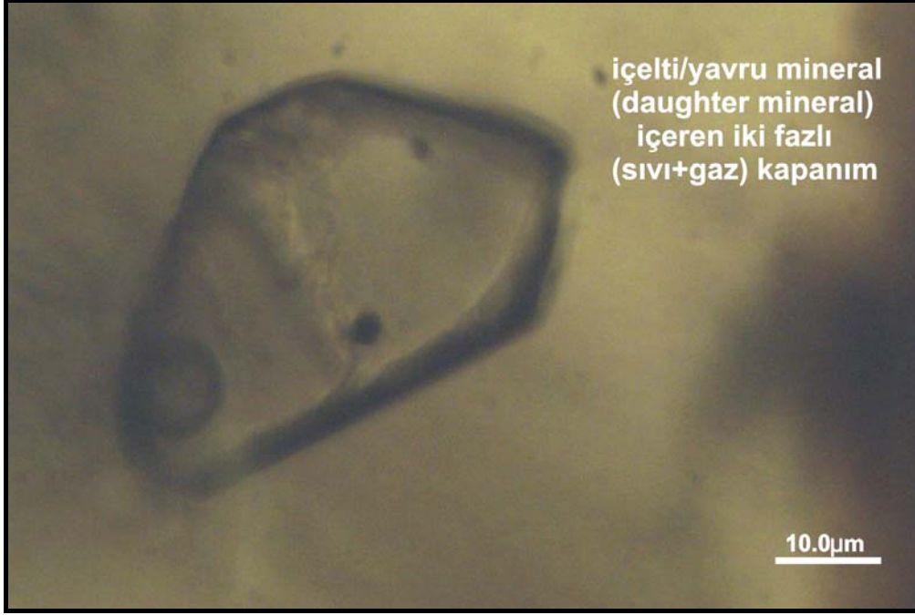
Şekil 7.3 CB 15-2 nolu örneğin bal rengi sfaleritlerinde görülen içelti/yavru mineraller (daughter minerals) içeren iki fazlı (sıvı+gaz) kapanımlar
