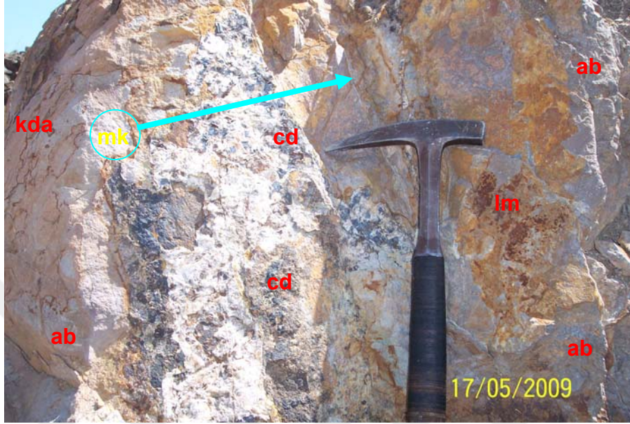
Şekil 5.20 Yarmanın K 80 ° B doğrultulu kuzeydoğu fay aynasında (kda) ileri derecede altere bazaltlar içinde (ab) ve K 36 ° D doğrultulu makaslama kırığında (mk) sülfütlü kuvarslı cevher damarı (cd) ve kırıklarda limonitleşmeler (lm)
