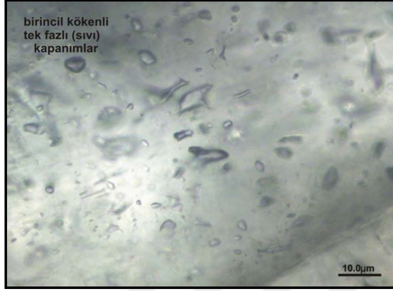
Şekil 7.5 CB 10 no'lu örneğin baritlerinde izlenen tek fazlı (sıvı) kapanımlar
